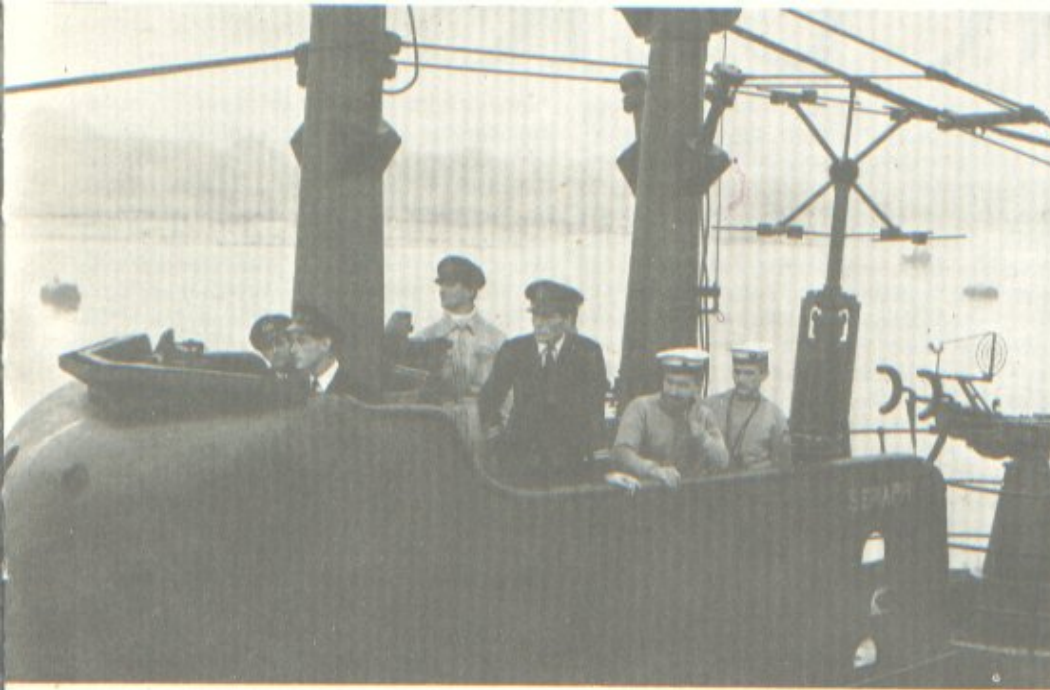
Gore: Komandni most podmornice «Seraph» s radarskom antenom za zračno osmatranje s desne strane periskopa, te sa zatvaračkim mehanizmom 20 mm protuavionskog topa. Kao «brod sa dva komandanta» izvršila je nekoliko zadataka zaštićivanja.
