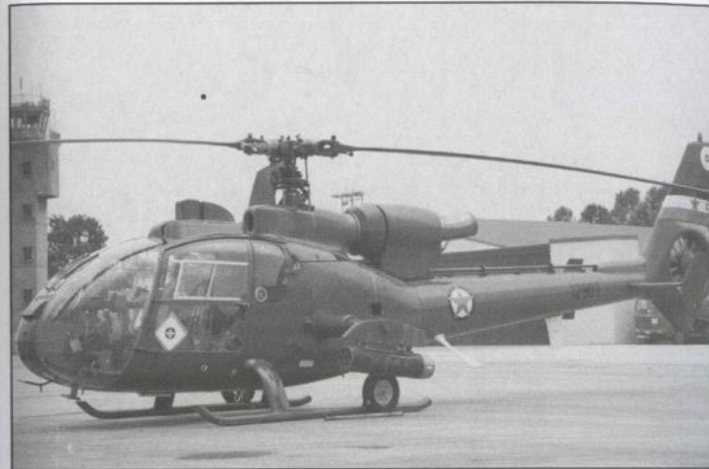
Poboljšana verzija helikoptera Gazela Sa-342 ušla je u proizvodnju i kao naoružana verzija HN-45M Gama. Na slici je njen prototip u toku ispitivanja lansera LLU-007 u VOC-u, Batajnica. (VOC)
