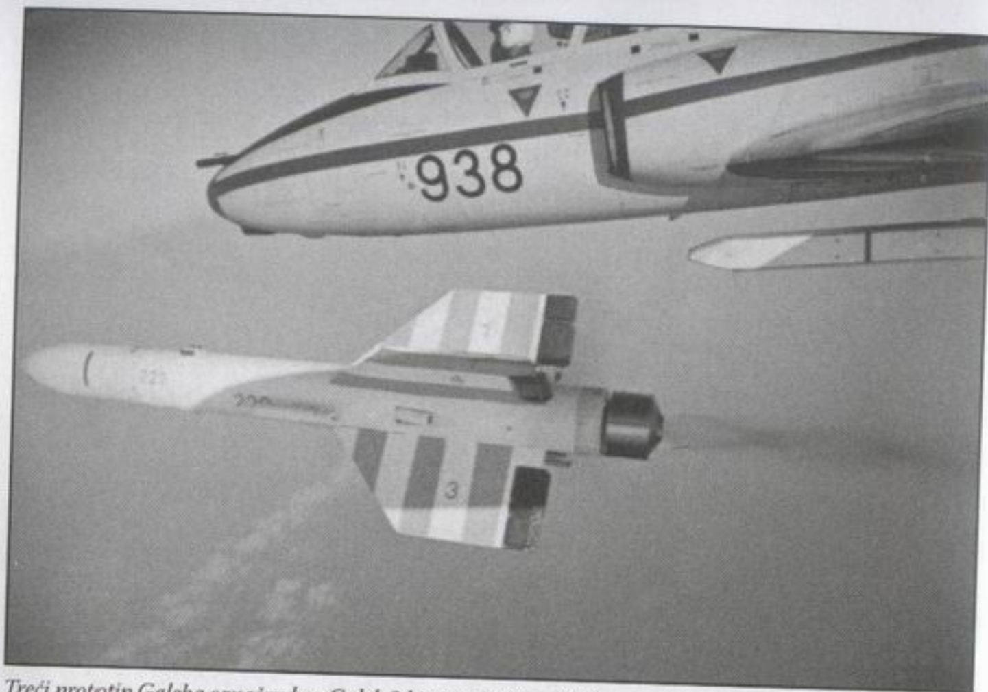
Treći prototip Galeba označen kao Galeb 3 bio je značajna platforma za ispitivanje. Ovde u trenutku lansiranja mete PRM-200 (VOC)
