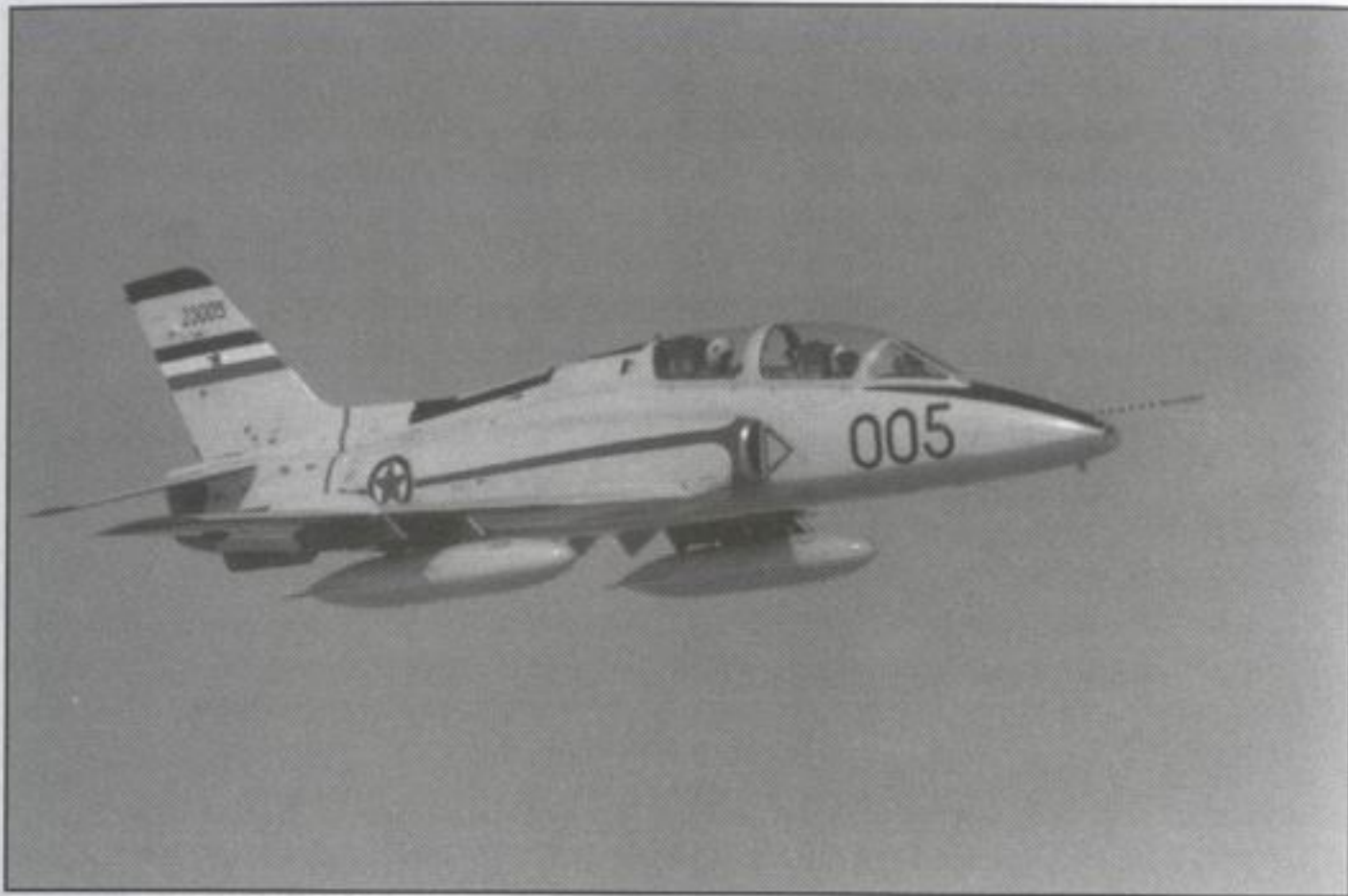
Drugi prototip Super Galeba (23005) poletio je 14. decembra 1979. godine. Ovaj primerak sa celopokretnim horizontalnim repom, postao je obrazac za serijsku proizvodnju. (VOC)
