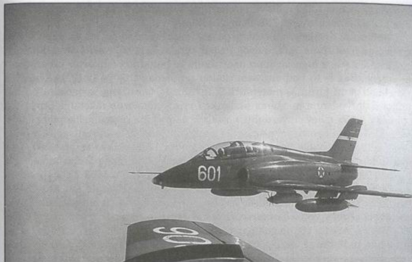
Prvih šest primeraka G-4 ušli su 1982. u sastav 525. trenažne eskadrile. Neki od ovih primeraka dobili su uredaj za vuču meta koji je izradio VZ Zmaj iz Velike Gorice. (D. Veličković)
