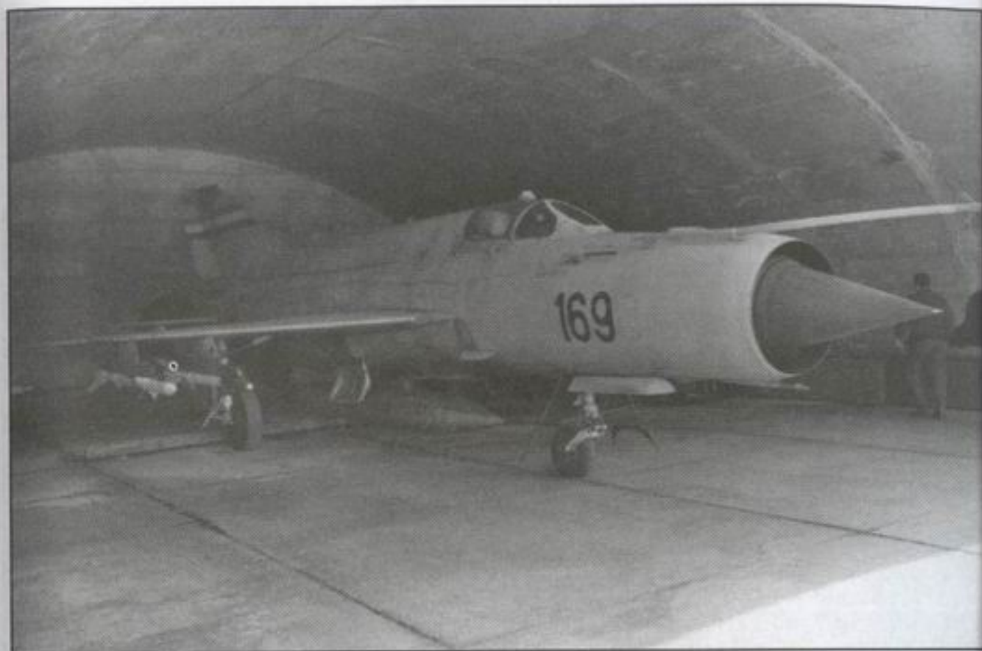
U armirano-betonskom skloništu i naoružan raketama vazduh-vazduh avion L-17, broj 17169 iz sastava dežurne pare 204. lovačkog puka (M. Micevski)
