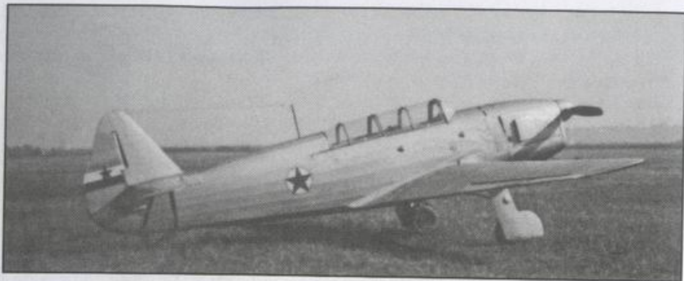
Prototip aviona 212 u toku prvih ispitivanja jula 1948. Iako skladnih linija baziranih na predratnom Ika-3, i proizvedene veće serije, ovaj tip se nije pokazao veoma uspešnim rešenjem. (VOC)
