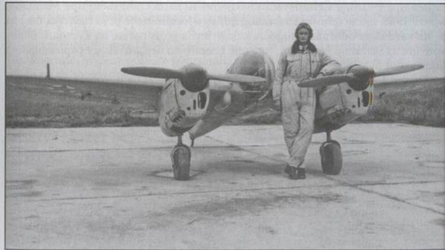
Posleratni nastavak eksperimentalnog projekta aviona sa pilotom u ležećem položaju konstruktora Bešliina bili su avioni 232 i 451. Na slici probni pilot Tugomir Prebeg pored aviona 232. (VOC)
