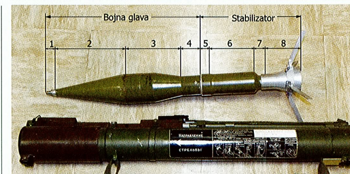
Ročni raketomet za enkratno uporabo RPG-22 »Netto« in elementi mine ročnega raketometa RPG-22: 1 Piezo generator; 2 Balistična kapa - vžigalni del; 3 Kumulativna bojna glava; 4 Položaj električnega sprožilca; 5 Spoj raketnega motorja z bojno glavo; 6 Raketni motor; 7 Prižigalo raketnega motorja; 8 Šoba raketnega motorja z nameščenimi krilci za stabilizacijo leta.
