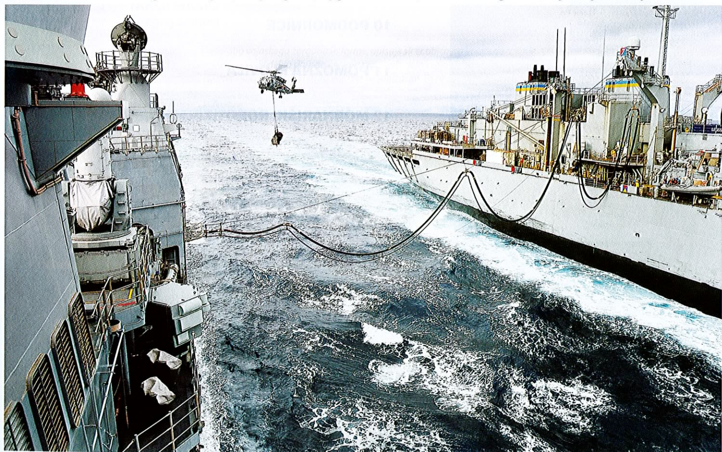
Delovanja sodobnih vojnih mornaric brez podpore pomožnih ladij ni. Na posnetku so ameriške vojne ladje med oskrbo na morju (med plovbo). (Foto: US Navy)
