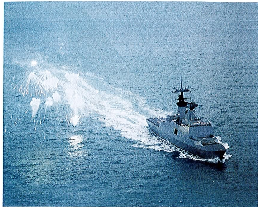
Za obrambo pred protiladijskimi raketami ima večina plovil laserske radarske in infrardeče vab. Na posnetku je ladja neposredno po izstrelitvi radarskih vab. (Foto: EADS)
