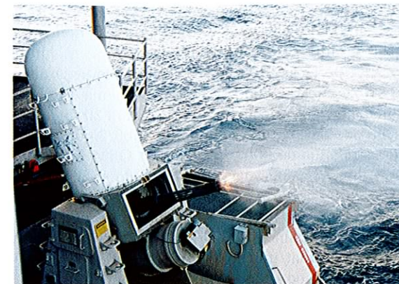
Za neposredno (zadnjo) obrambo predvsem pred protiladijskimi raketami in varovanje sil pred manjšimi površinskimi plovili uporabljajo avtomatske večcevne topove malega kalibra, kakršen je topovski sistem mk 15 phalanx na posnetku. (Foto: US Navy)
