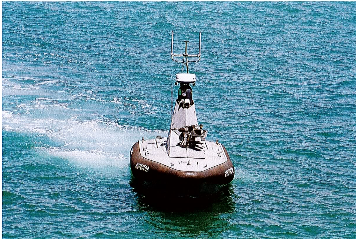
Ob sistemih s človeško posadko v sodobnih vojnih mornaricah dobivajo vse večji pomen zračni (letalski), površinski in podvodni sistemi brez človeške posadke, kakršno je površinsko plovilo protektor. (Foto: Rafael)
