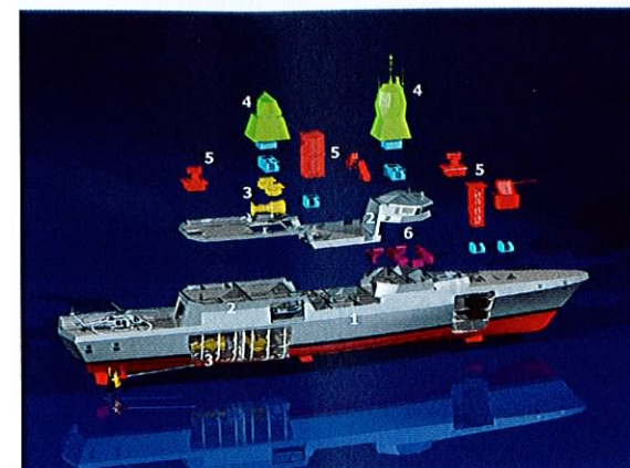
Gradnja večine sodobnih vojnih plovil je modularna in temelji na preizkušenem nemškem (Blohm & Voss) modularnem in večnamenskem konceptu MEKO (Mehrzweck-Kombination). Legenda: 1 - trup plovila, 2 - nadgradnja, 3 - pogonski sistem (glavni pogonski stroj, sistem prenosa, vijak), 4 - glavni senzorji za nadzor površine in zračnega prostora, 5 - oborožitveni sistemi s senzorji za nadzor ognja, 6 - poveljniški most z informacijsko-komunikacijskimi sistemi in sistemi za nadzor glavnih sistemov na plovilu (Risba: Blohm & Voss)
