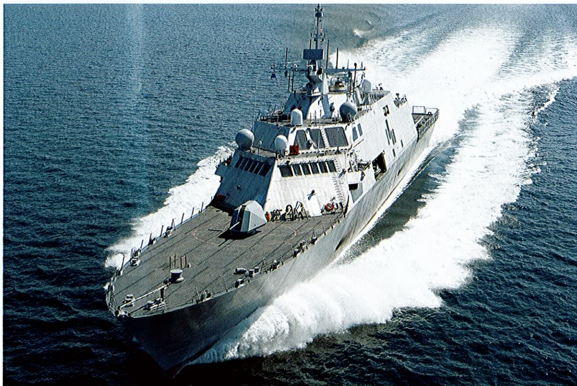
Razviti in zgraditi učinkovito vojno plovilo je proces, ki mora uravnotežiti v izbranem trupu najmanj tri glavne elemente: pogon, oborožitev in senzorje, in to tako, da bodo ob vsem zagotovljeni tudi najbolj optimalni pogoji za delo in bivanje posadke. Na posnetku je USS Freedom (LCS 1), obalna vojna ladja ameriške vojne mornarice, optimalna za delovanje v obalnih vodah. (Foto: US Navy)
