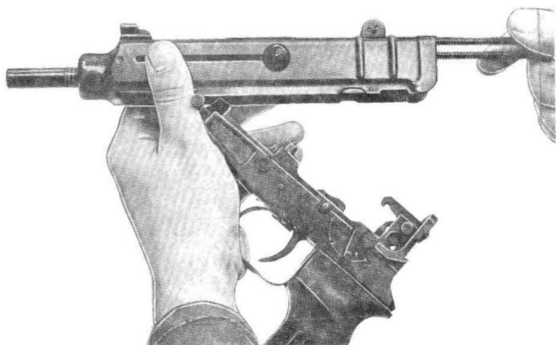
Sl. 52 – Dovođenje zatvarača u položaj za odvajanje hvatača za povlačenje zatvarača
