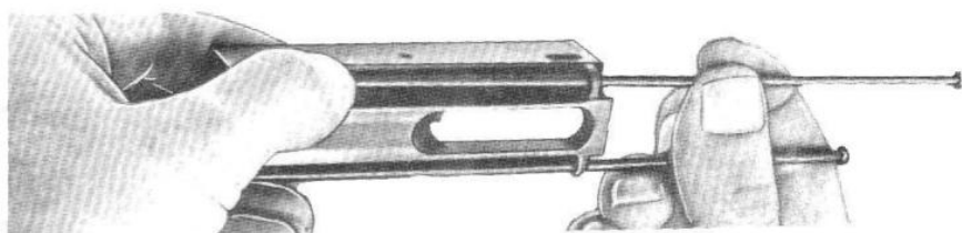
Sl. 66 – Odvajanje vodica povratnih opruga od sklopa zatvarača
