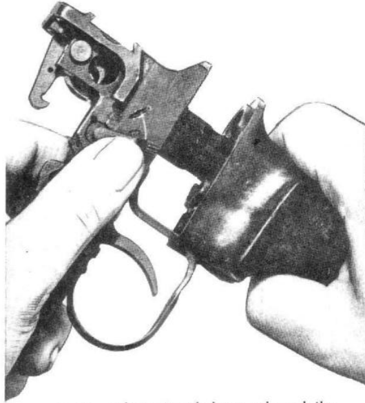
Sl. 70 – Odvajanje rukohvata od usadnika
