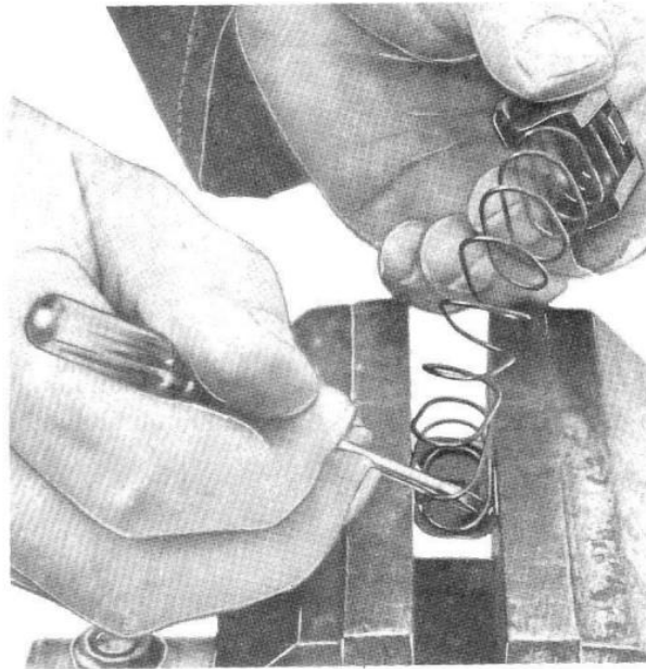
Sl. 101 – Odvajanje utvrđivača dna okvira od opruge donosača
