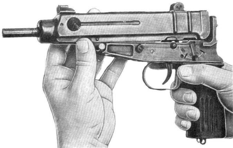
Sl. 50 – Povlačenje vodice zatvarača napred i izvođenje iz zahvata sa usadnikom
