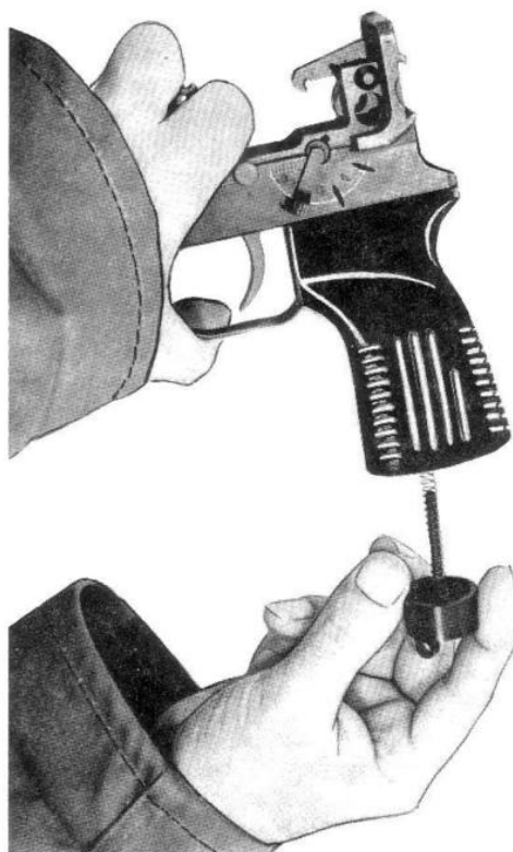
Sl. 111 – Ubacivanje opruge i podloške rukohvata u usadnik i usporivač
