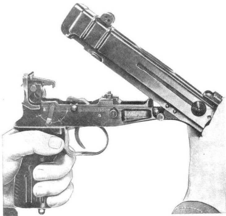
Sl. 51 – Zakretanje vodice zatvarača
