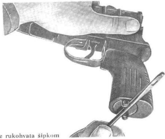
Sl. 69 – Odvijanje navrtke rukohvata šipkom
