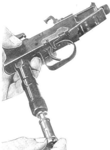
Sl. 71 – Odvajanje usporivača od usadnika
