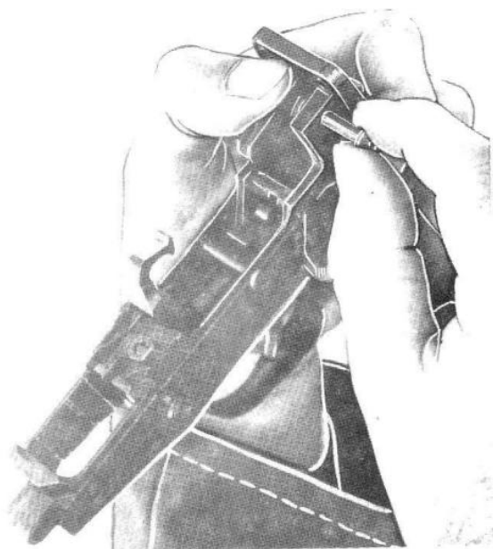
Sl. 72 - Odvajanje delova za zadržavanje zatvarača od usadnika
