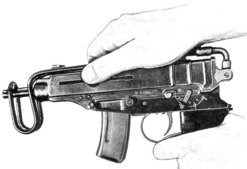
Sl. 114 - Povlačenje zatvarača nazad radi zapinjanja udarača i punjenje pištolja
