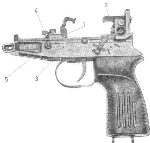
Sl. 5 – Usadnik, (sklop) sa delovima mehanizma za okidanje, usporenje brzine gadanja i zadržavanje zatvarača:
