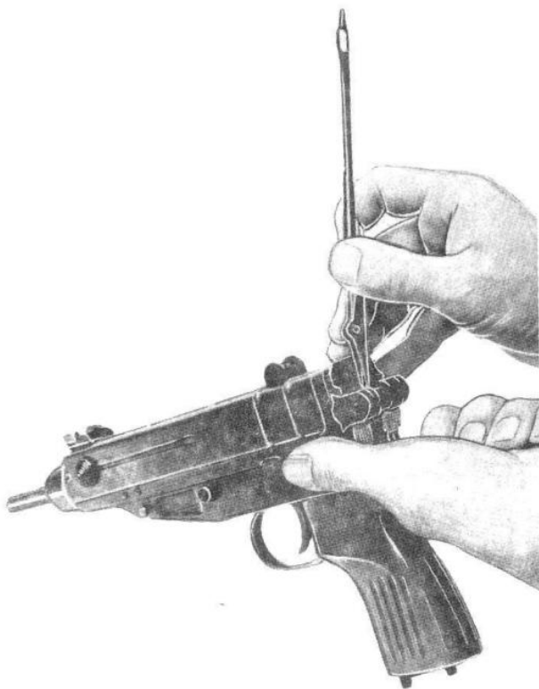
Sl. 47 – Isključivanje utvrđivača kundaka iz zahvata sa usadnikom
