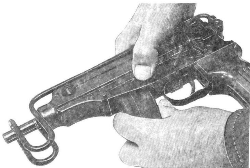
Sl. 45 – Odvajanje okvira od pištolja
