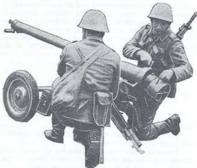
Sl. 46 — Rad pomoćnika nišandžije pri zabavljanju zatvarača
