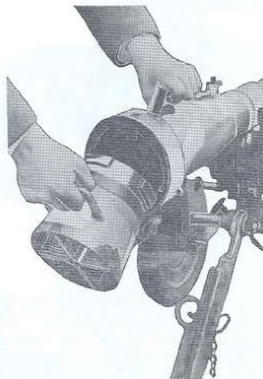
Sl. 32 — Otvaranje topa i zapinjanje mehanizma za zapinjanje i okidanje
