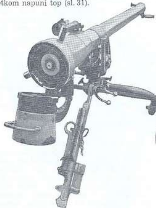
Sl. 31 — Punjenje topa vežbovnim metkom M65 sa metkićem
