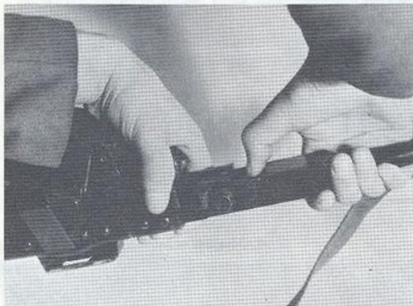
Sl. 62. Odvajanje gasnog cilindra
