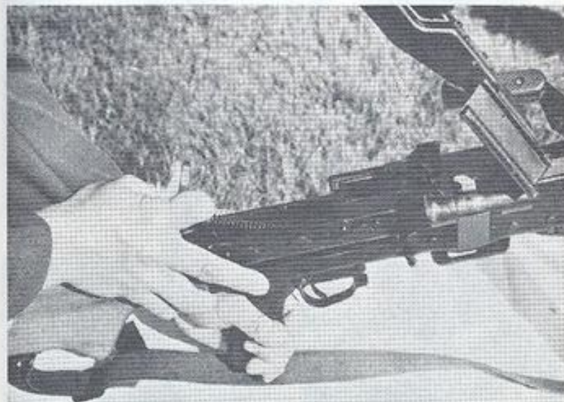
Sl. 57. Odvajanje povratnog mehanizma
