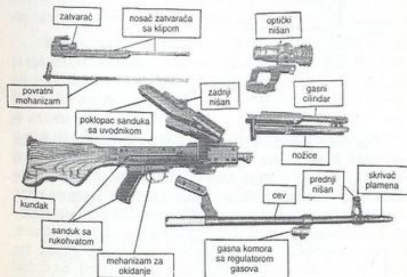
Sl. 2. Glavni delovi mitraljeza
