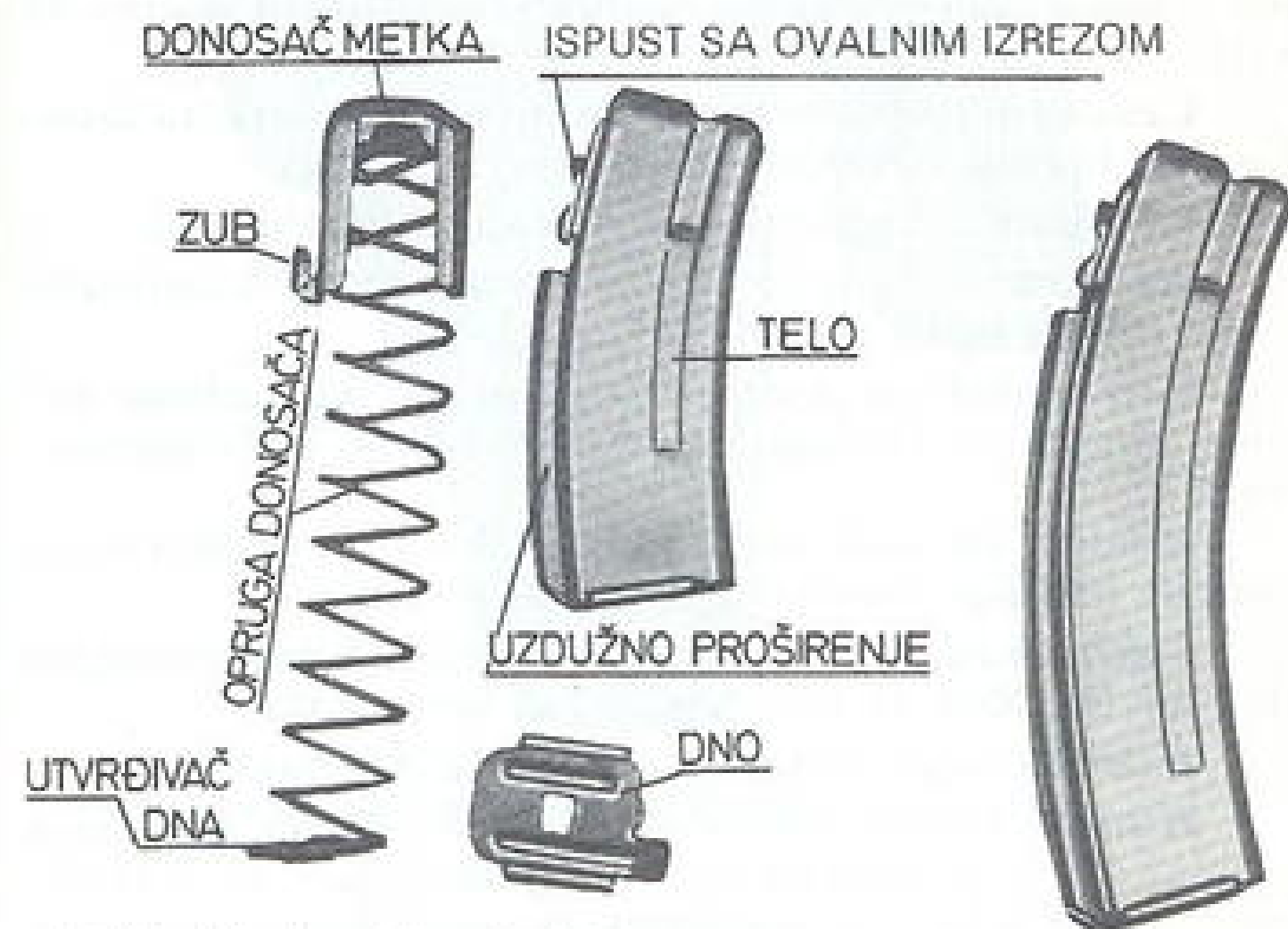
a) delovi kratkog (dugog) okvira
