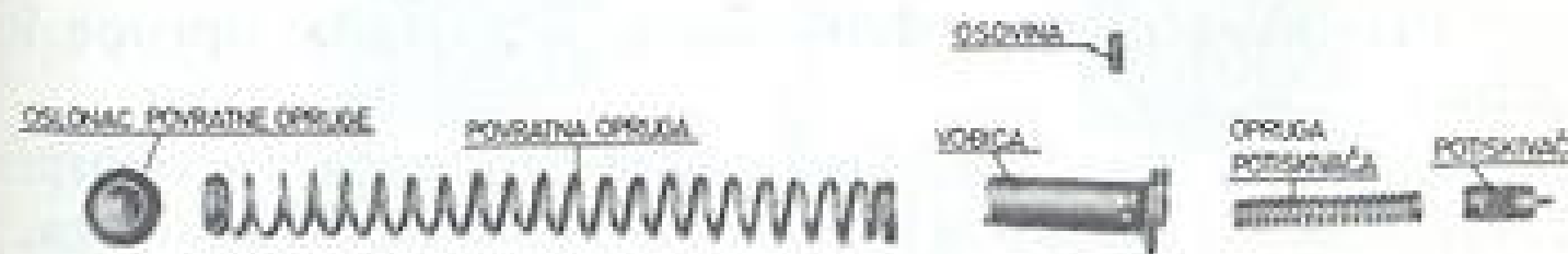
Sl. 7 - Povratni mehanizam pištolja M70
