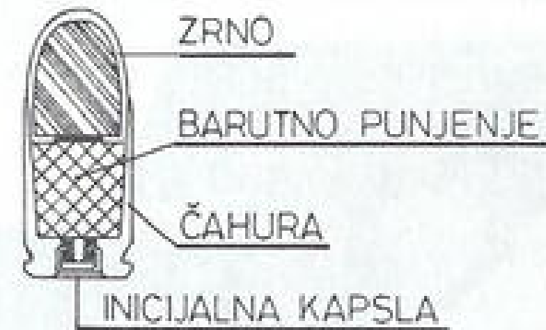
Sl. 14 - Delovi bojnog metka 7,65 mm
