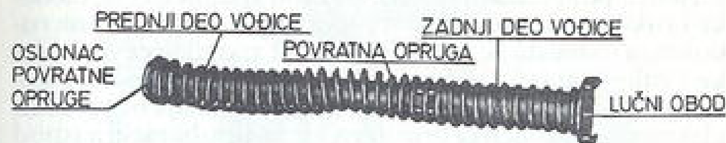
Sl. 6 - Povratni mehanizam pištolja M57
