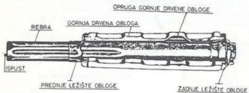
Sl. 7 - Delovi gasnog cilindra
