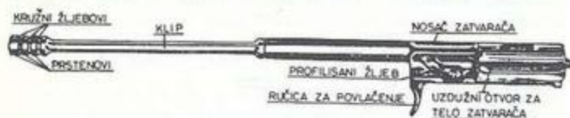
Sl. 10 – Delovi nosača zatvarača i klipa
