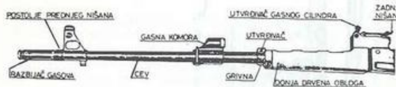
Sl. 3 – Delovi cevi sa razbijačem gasova
