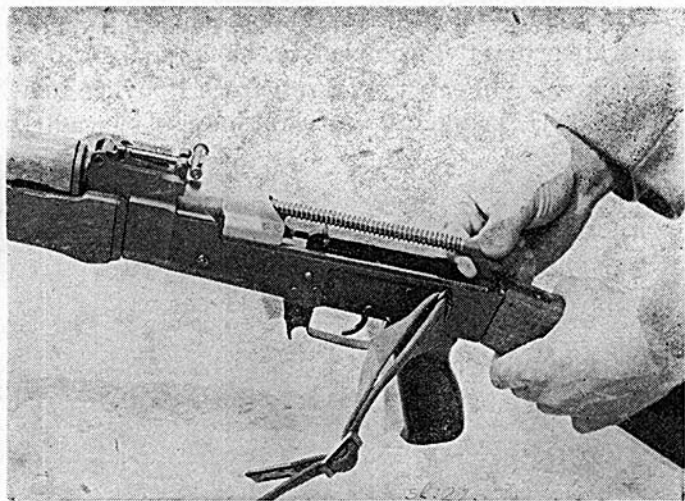
Sl. 22 — Odvajanje povratnog mehanizma
