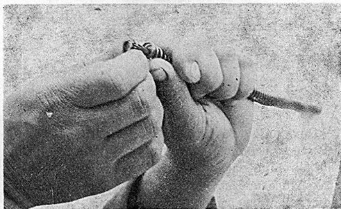
Sl. 23 — Rasklapanje povratnog mehanizma
