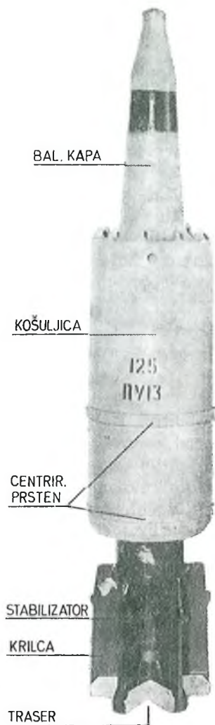
Sl. 153 — Kumulativni projektil ZBK14M
