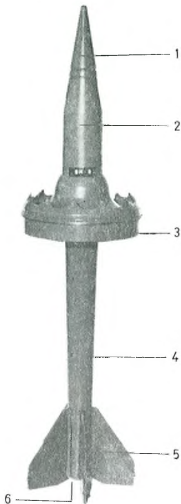
Sl. 155 — Potkalibarni projektil BM9
