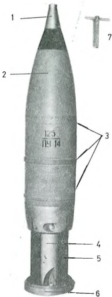
Sl. 152 — Trenutno-fugasni projektil OF-19
