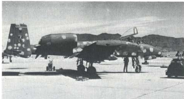
Slika 3 – A-10 »fercailld« sa maskom na sistemu JAWS koja je namenjena za korišćenje u pustinjskim predelima (FS 34102 maslinasto zelena – osnovna boja; FS 34092 – tamno zelena – fleke; FS 30118 – mrka – fleke; FS 30227 – boja peska – fleke; FS 36231 – siva – fleke).
