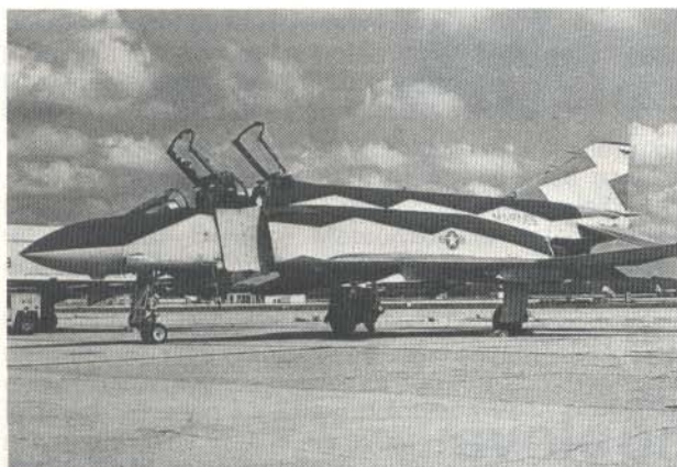
Slika 1b – Maskirna šema tipa »feris« kopija šeme maskiranja »splinter« iz II svetskog rata na »fantomu« F-4. (FS 36440 – »feris« tamno siva; FS 36231 – tamno siva boja galebova; FS 36320 – tamno »kompas-duh« siva boja)
