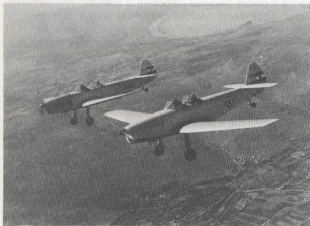
Slika 3 – »Aero-2« prvi školski avion domaće konstrukcije koji je bio namenjen za početnu obuku pilota-pitomaca VVA
