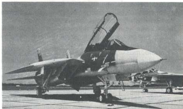
Slika 2 – Maska za Bliski istok na F-14 »tomket« (FS 34079 – maslinasto zelena; FS 30140 – azijsko braun; FS 30400 – žuto mrka; FS 36622 – siva boja – za donje površine).
