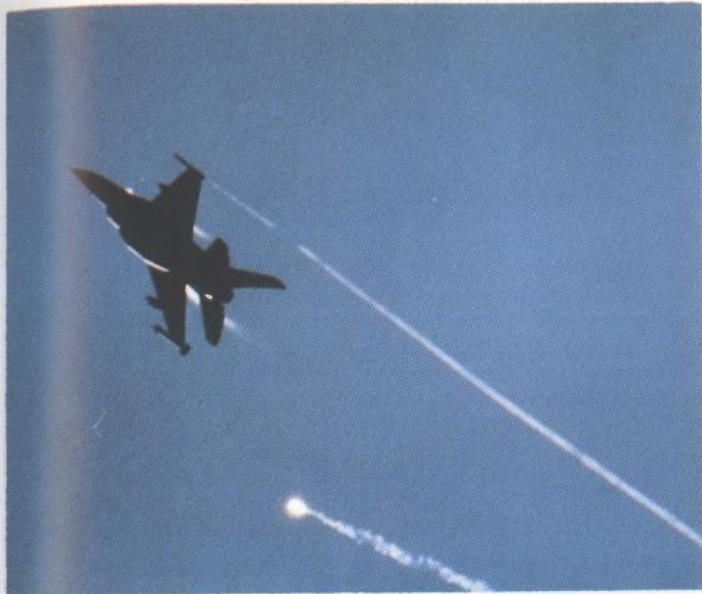
Slika 3. Zrakoplov F-16 lansira IC baklju, jednostavna ali i učinkovita protumjera za samonavodeće rakete prve i druge generacije
