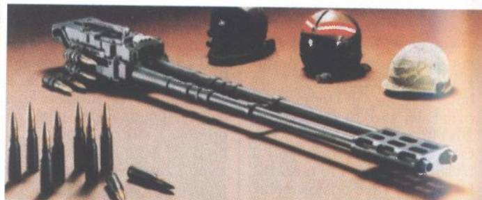
Automatski top tvrtke General Electric GE-225 napravljen je za kalibar 25 mm. Namijenjen je ugradnji na helikoptere i borbena vozila
