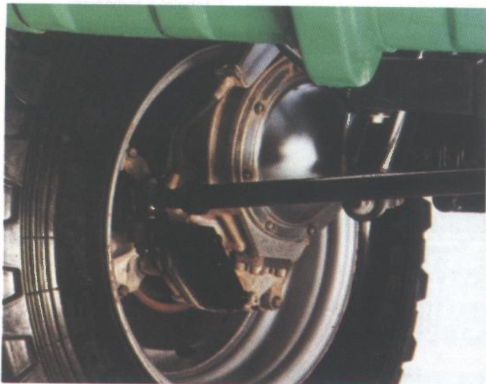
Pogled na unutarnju stranu kotača prednjeg mosta (bočni prijenos, upravljačka spona, disk kočnica)
