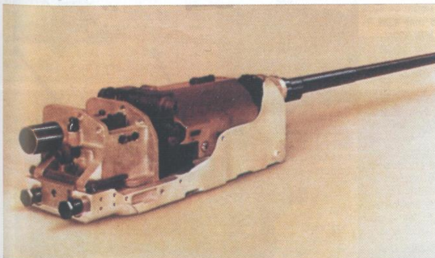
Top ADEN kalibra 25 mm engleske tvrtke Royal Ordnance namijenjen je ugradnji na zrakoplove HARRIER
