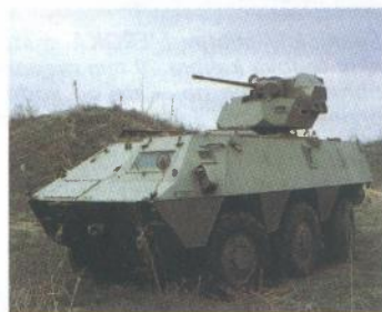
Španjolski proizvođač Santa Barbara izrađuje univerzalne kupole koje se mogu montirati na različite tipove oklopnih vozila. Na slici je prikazana kupola TC-13 s topom kalibra 25 mm
