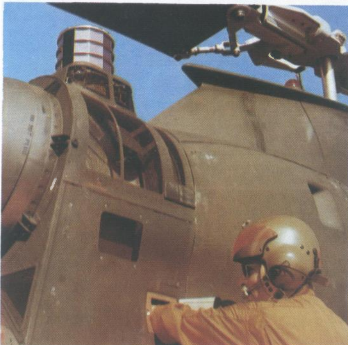
Slika 8. AN/ALQ-144A, za zavaravanje sustava i samonavodećih raketa u IC spektru, montiran na helikopter COBRA. Isti se montira i na helikoptere BLACKHAWK
