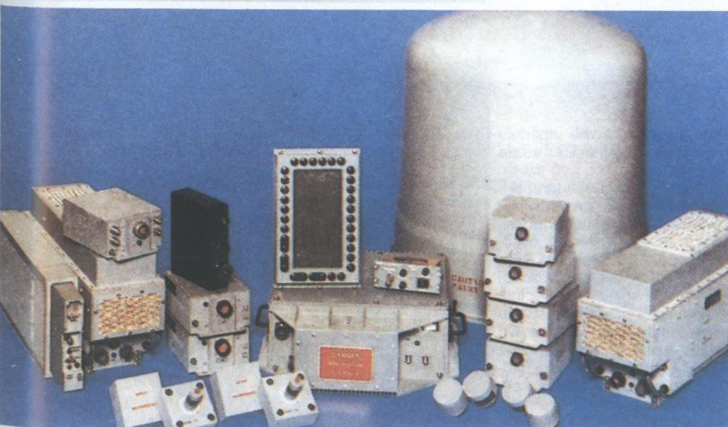
Slika 11. AN/ALR-66(V)6 jedan je od najmodernijih modela od sustava serije 66(V). Specijalno je projektiran za uporabu na brodu a može djelovati odvojeno i u sprezi s lanserima radarskih mamaca i baklji. On locira i identificira neprijateljske i prijateljske emitere oružnih sustava, u pojasevima od C do J, s preciznošću potrebnom da brodski obrambeni sustav djeluje učinkovito
