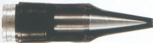
Automatski top 25 mm KBB koristi metak 25x288 mm koji je dosta snažniji u odnosu na metak topa KBA
