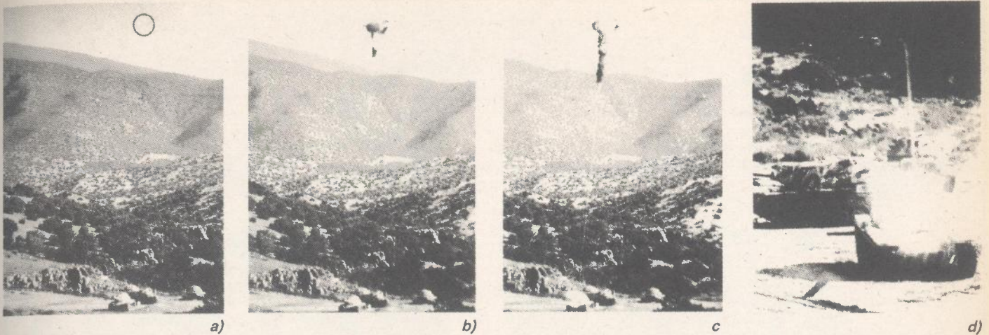
SADARM senzorski aktivirano streljivo na djelu: a) pretraživanje; b) detekcija cilja i ispaljenje EFP-a; c) trenutak udara u cilj; d) uništenje
