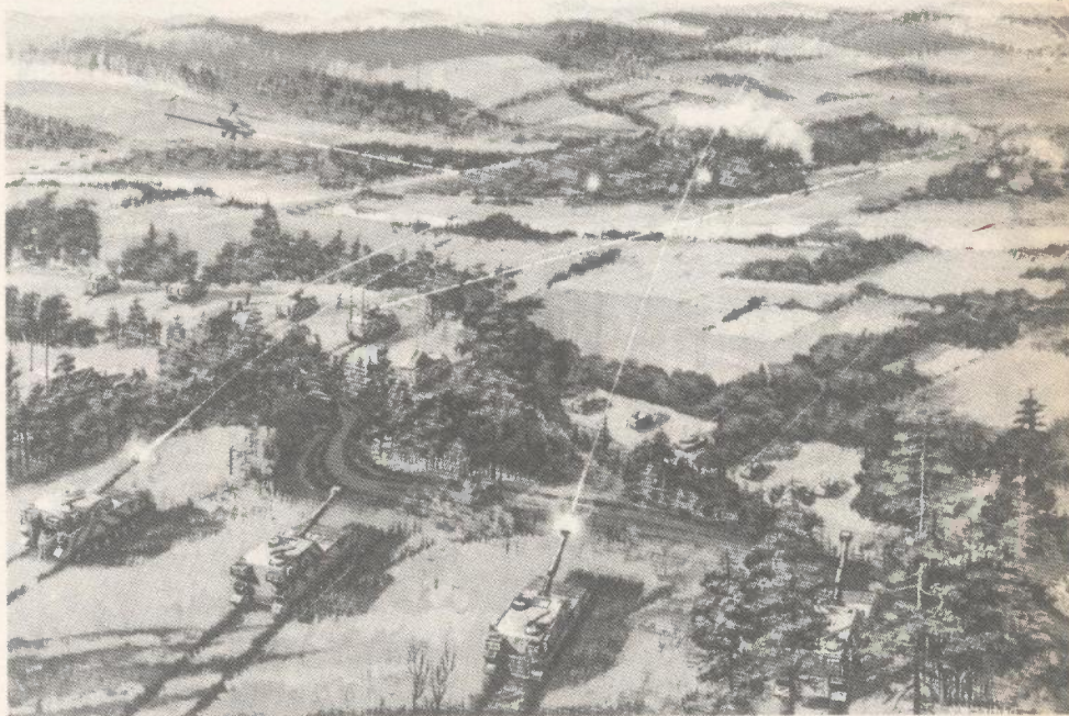
Scenarij uporabe COPPERHEAD streljiva uz obilježavanje cilja helikopterima i posebnim vozilima
