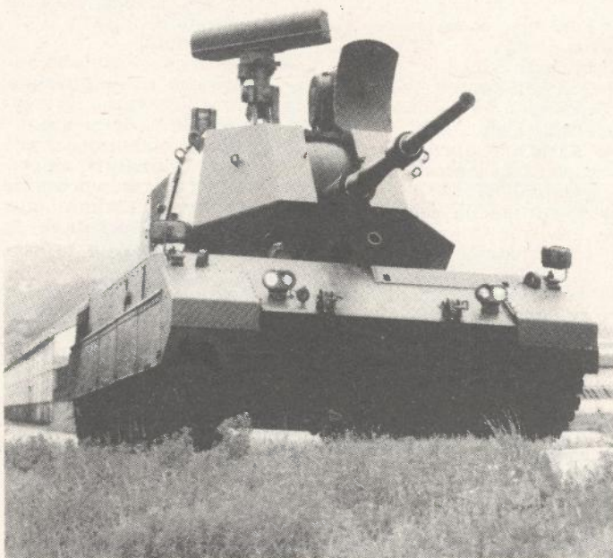
Samovozno topničko oružje razvijeno pri OTO Melari namijenjeno za protuzrakoplovne zadaće s OTOMATIC SP protuzrakoplovnim oružnim sustavom u sklopu kojeg se nalazi top SUPER RAPIDO 76 mm. OTOMATIC, kako se vidi na slici je postavljen na OTO Melara PALMARIA SP haubičko podvozje premda ga je moguće postaviti na bilo koje primjereno MBT podvozje
