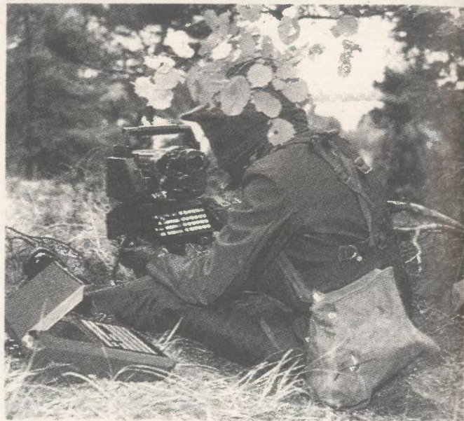
Istaknuti motritelj sadrži senzorski dio s goniometrom na tronošcu i računalsko-komunikacijskim terminalom
