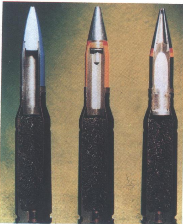
Različite vrste metaka kalibra 25x137 mm za francuski top 25M811. Slijeva nadesno: vježbovni metak, razorno-zapaljivi (ima 30 g eksploziva), i probojno-zapaljivi (probija oklop debljine 8 mm postavljen pod kutem od 60°)
