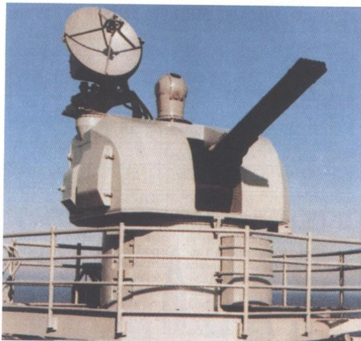
Španjolski sustav MEROKA sastoji se od čak dvanaest automatskih topova kalibra 20 mm raspoređenih u dva reda. Namijenjen je obrani plovnik objekata od vođenih raketnih projektila. Teorijska brzina gađanja iznosi 9000 metaka u minuti.
