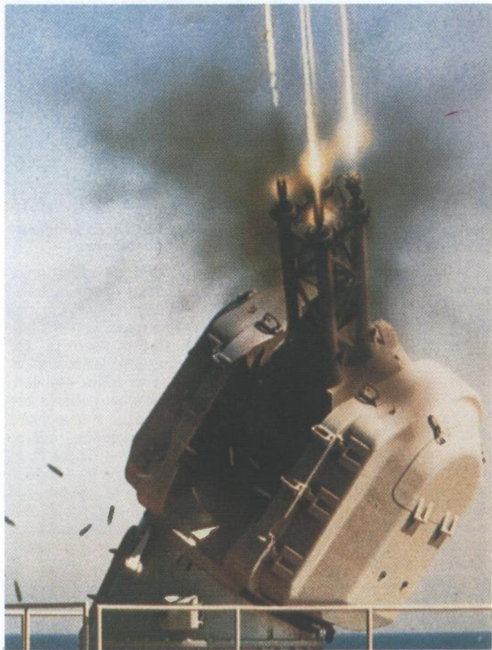
Brodsko inačica četvorocijevnog topa SEA ZENITH u kalibru 25 mm. Impresioniraju pokretne mogućnosti kupole koje osiguravaju učinkovito gađanje brodskih raketa i ciljeva u zraku
