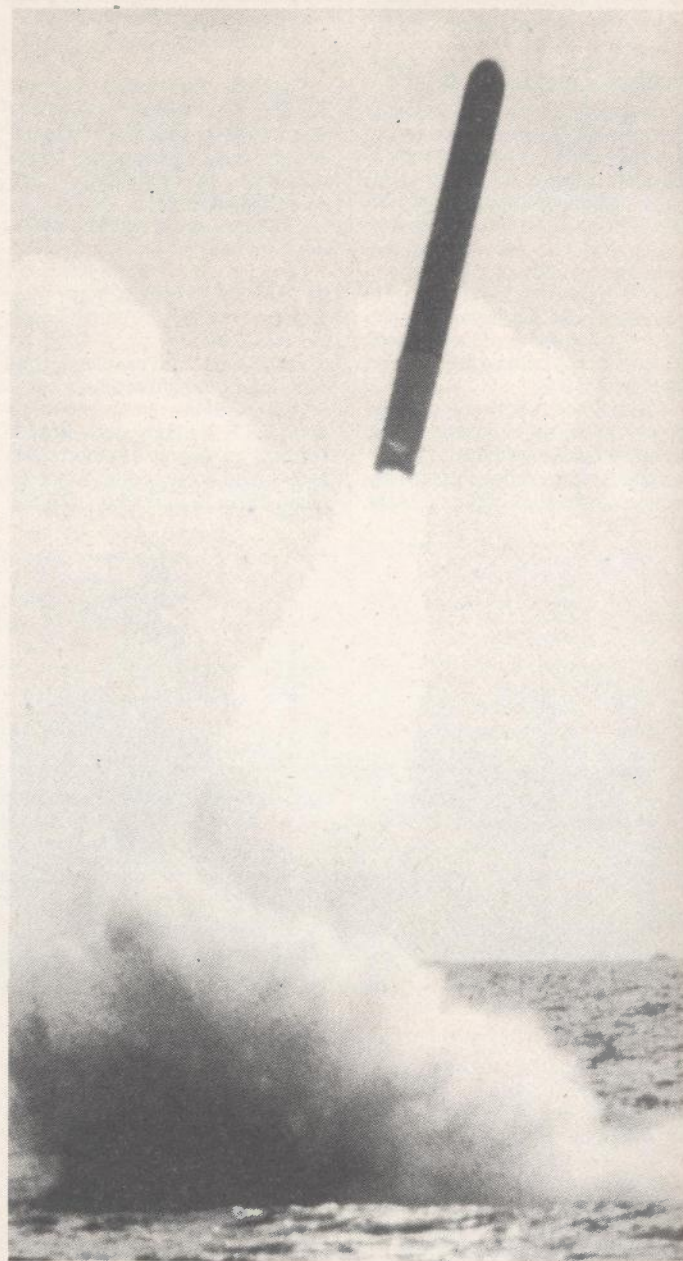
Tomahawk u trenutku izbijanja na površinu, izravno prije rasklapanja krila i vertikalnih stabilizatora (vidljiva je aerodinamička obloga između projektila i startnog motora, koja će biti odbačena)
