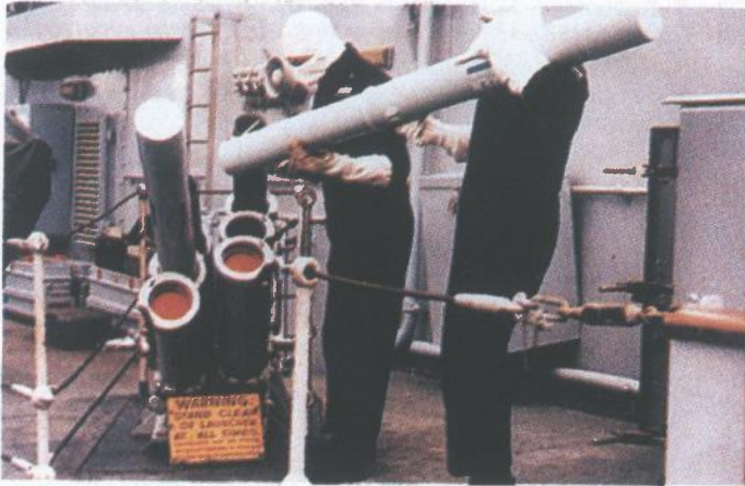
Slika 6. Prikaz GEC-Marconijeva lansera i radarskih mamaca za manje i srednje brodove. Isti je dio složenog sustava samoodbrane broda od raketa
