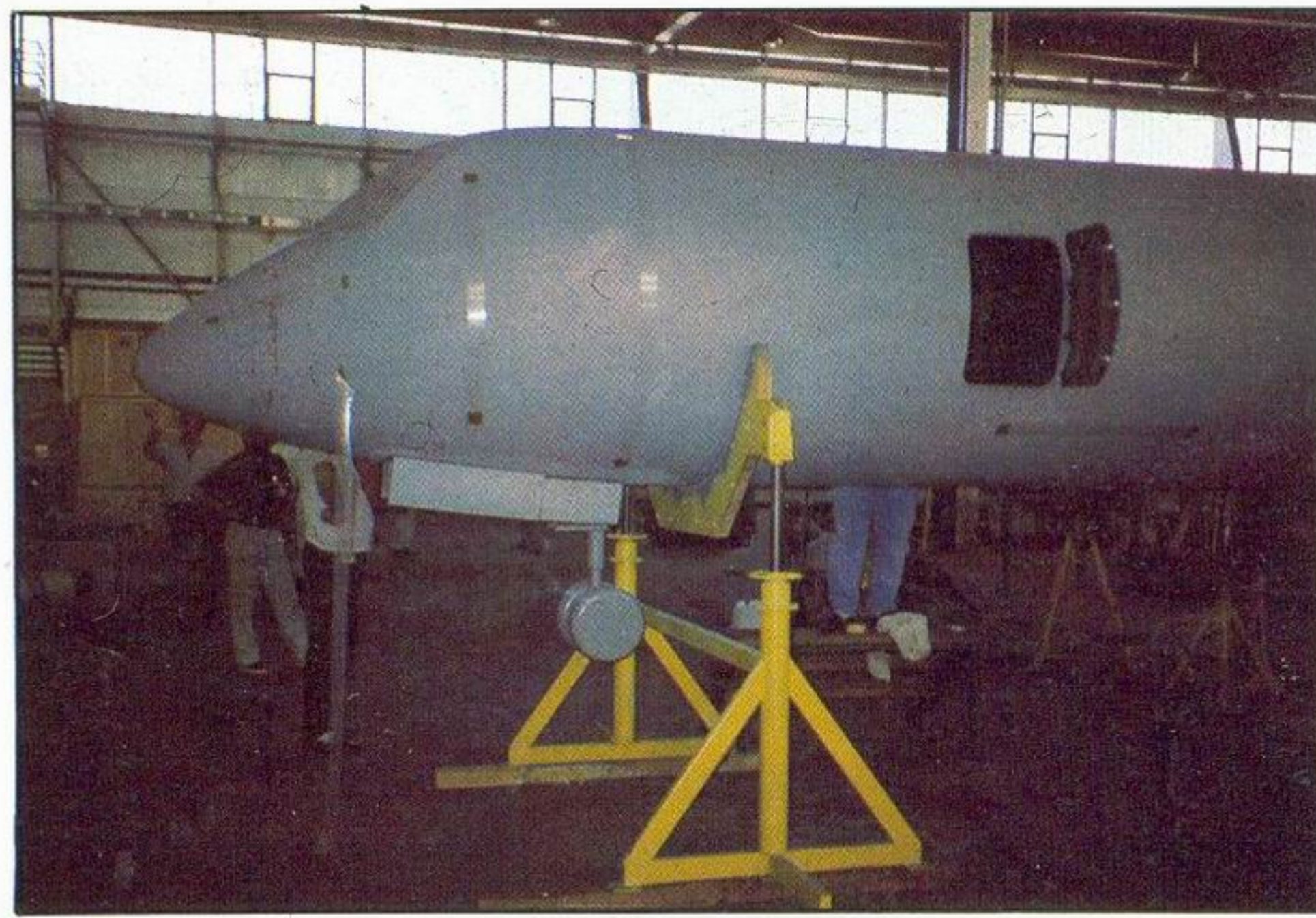
Kljun aviona sa uvlačivom prednjom nogom stajnog trapa i vratima za kontrolu opreme
