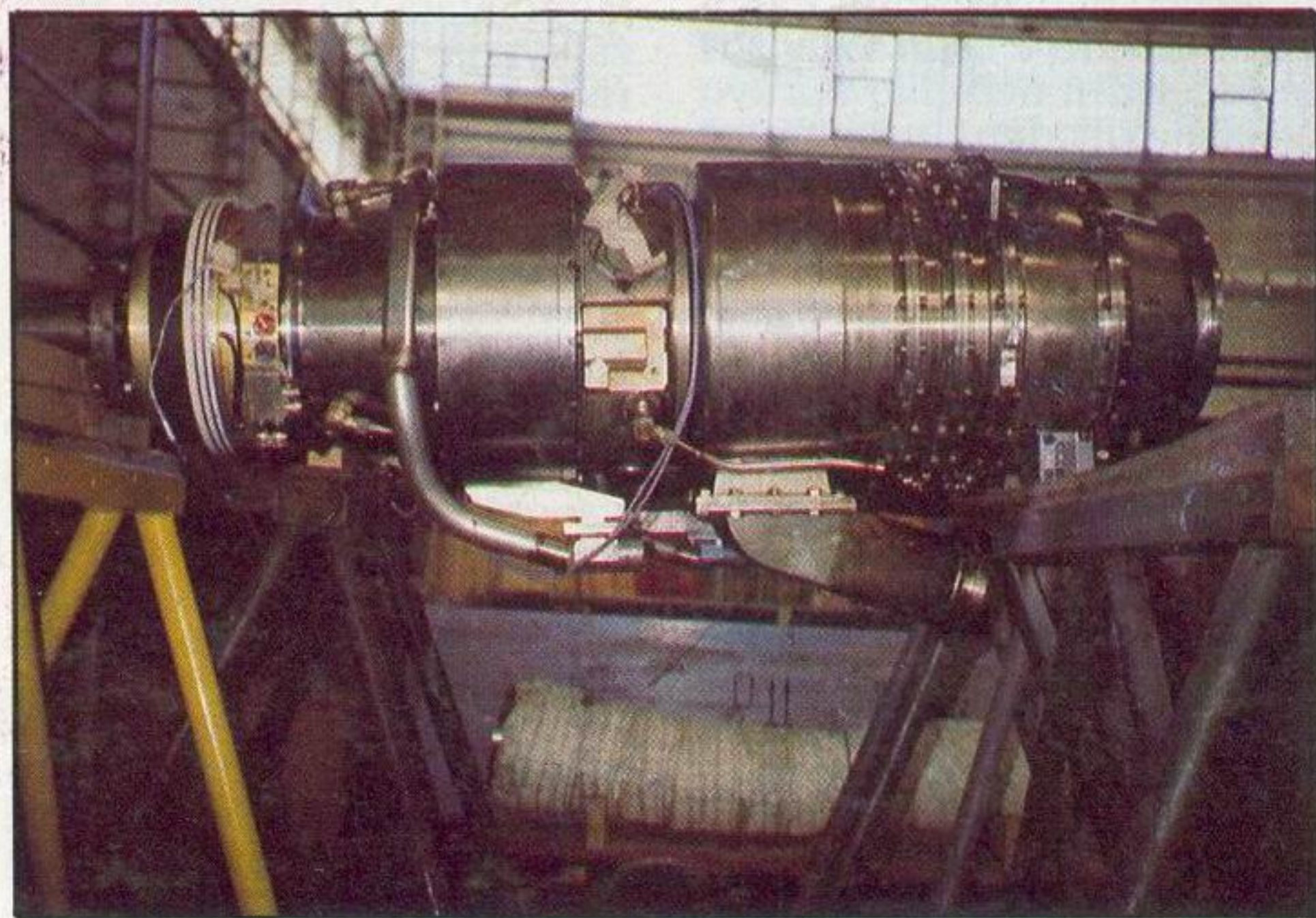
Jedan od dva motora na pogon toplim vazduhom, motor razvija snagu od 460 kW pri 2.400 obrtaja u minuti
