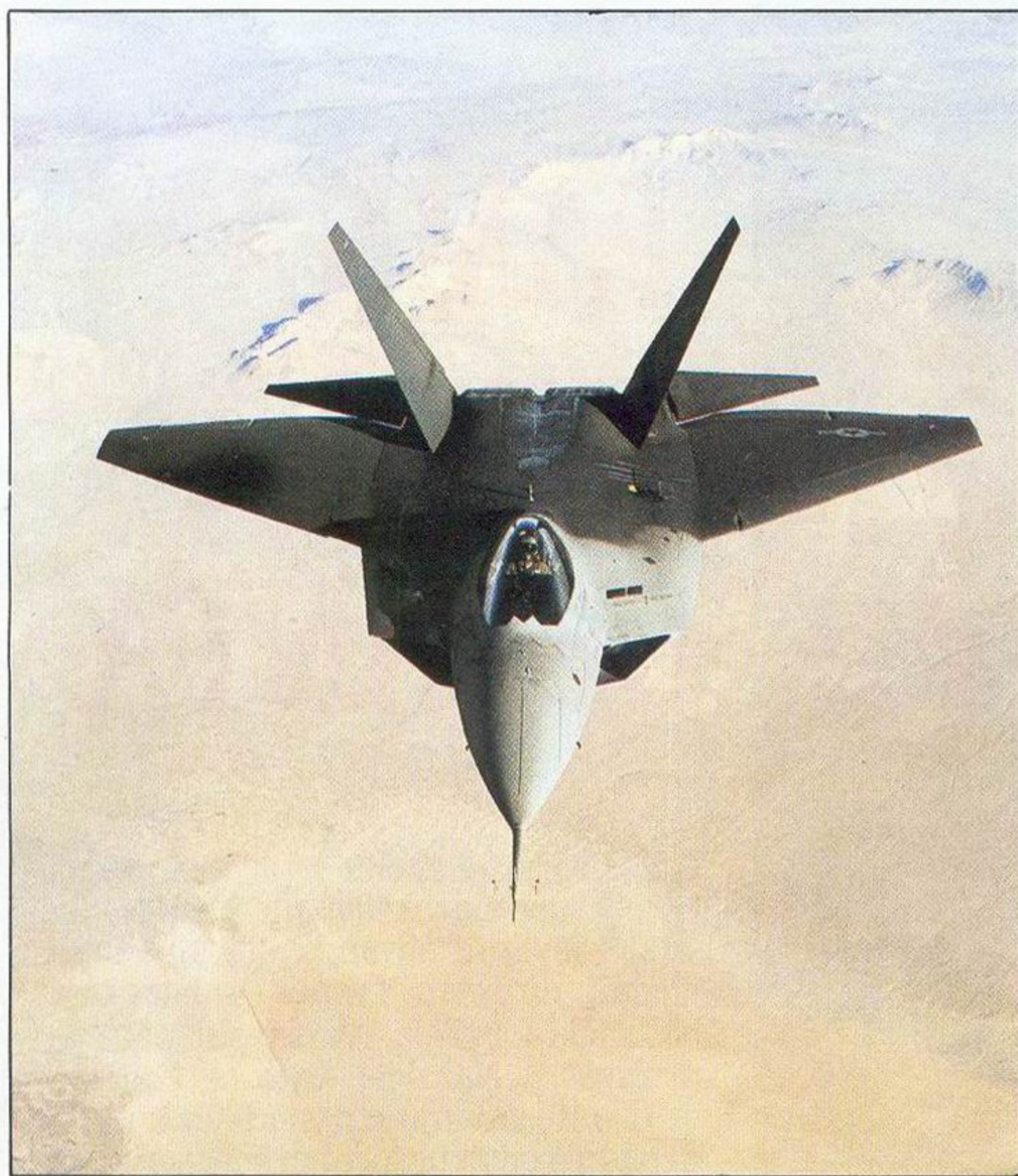
— »Pljosnata« konfiguracija YF-22 sve je cenjenija kod modernih lovaca kod kojih trup uz klasične funkcije obezbeđuje i deo uzgona
