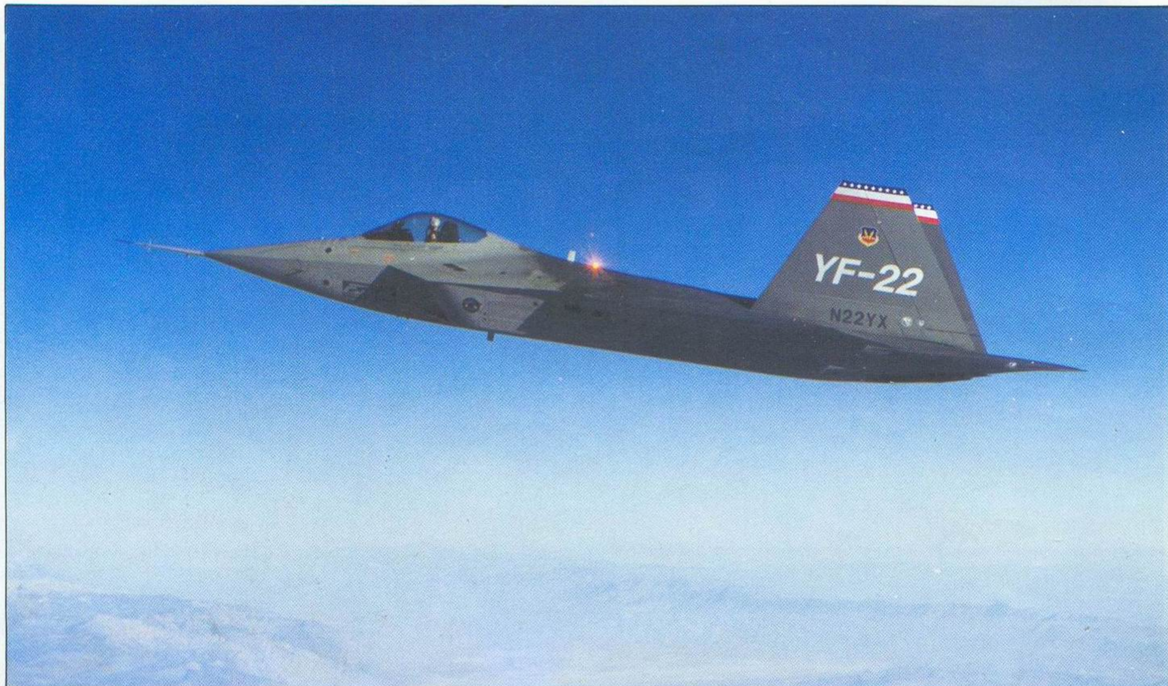
— Profil pobednika, lovac YF-22 rakete nosi u tri trupna spremišta kako bi zadržao stelt karakteristike
