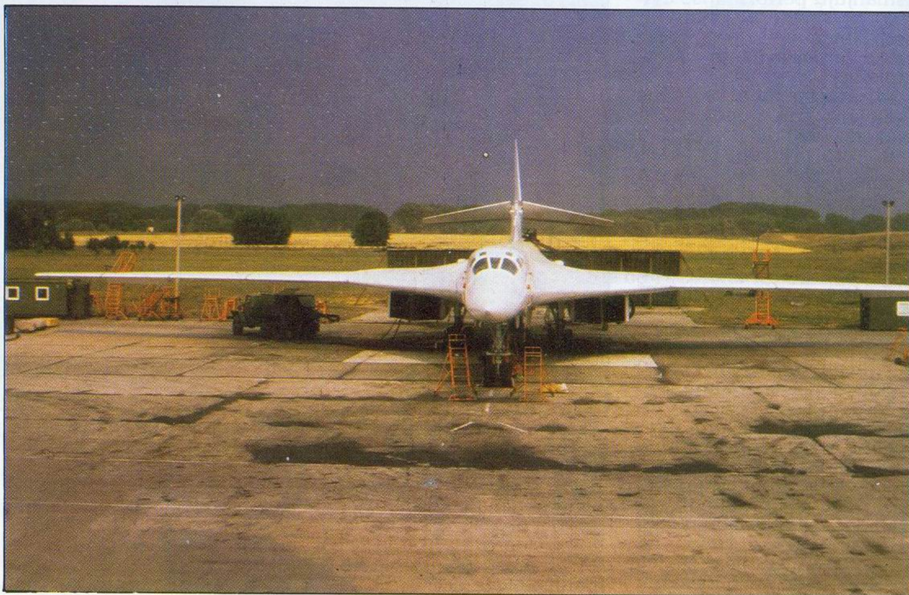
— TU-160 ima originalno rešenje vertikalnog kormila jer promenu smeru ostvaruje zakretanjem cele gornje polovine vertikalnog stabilizatora
