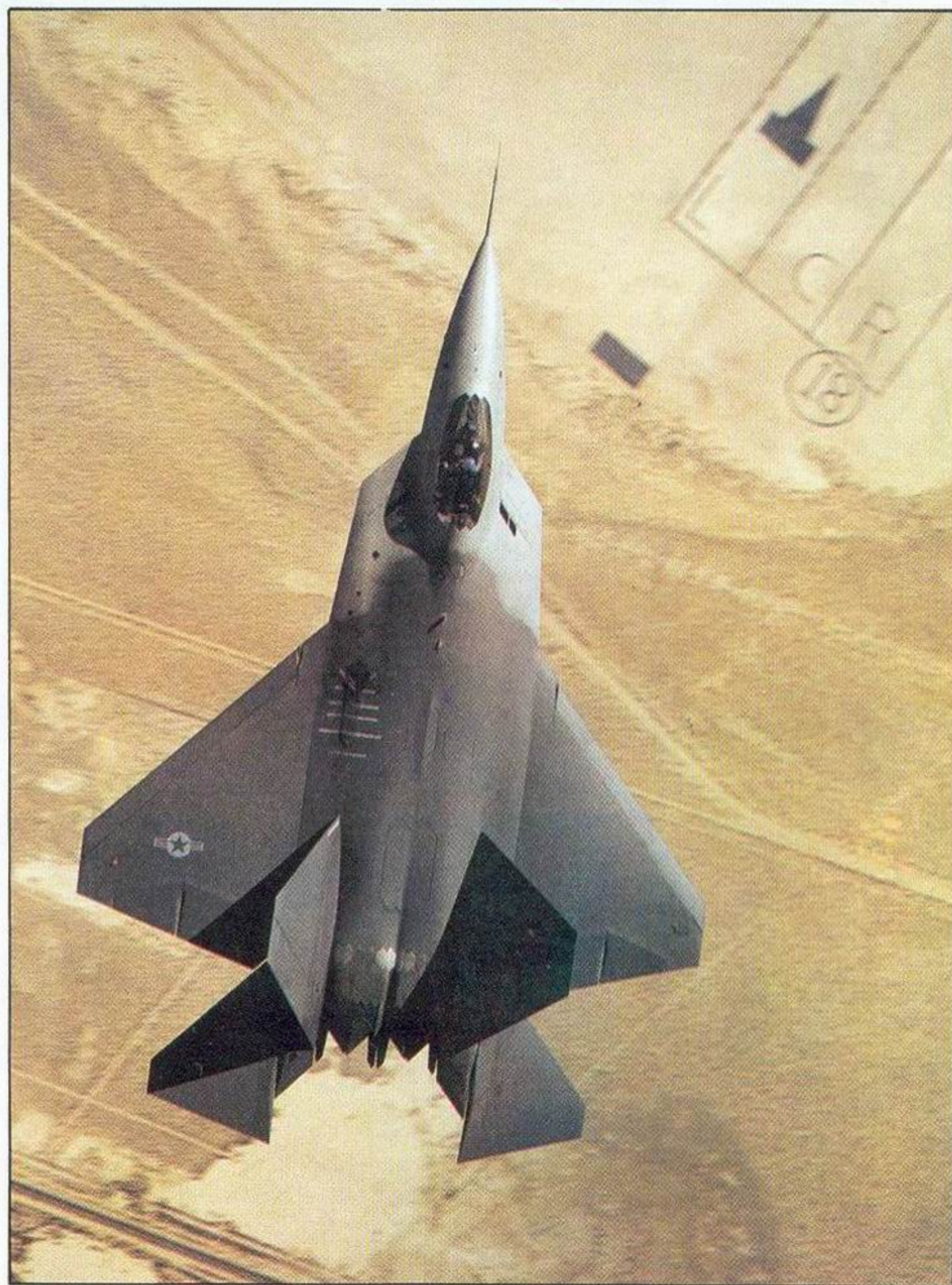
— Strela usisnika YF-22 ima ugao strele napadne ivice krila što veoma povoljno utiče na stelt karakteristike a zbog smanjene radarske vidljivosti je nazupčen i okvir kabine
