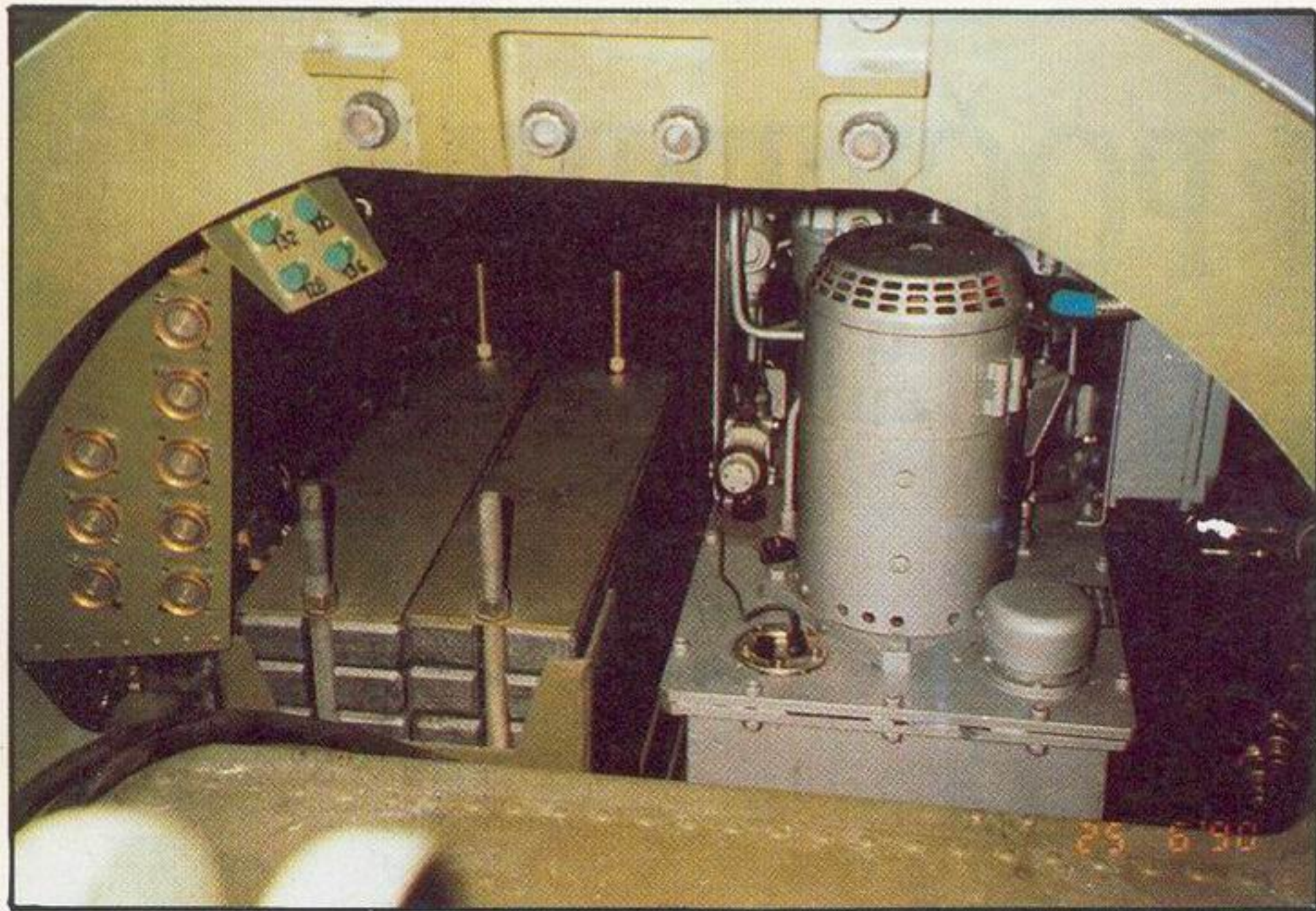
Pogon autonomnog hidrauličnog sistema ugrađen je u trup makete
