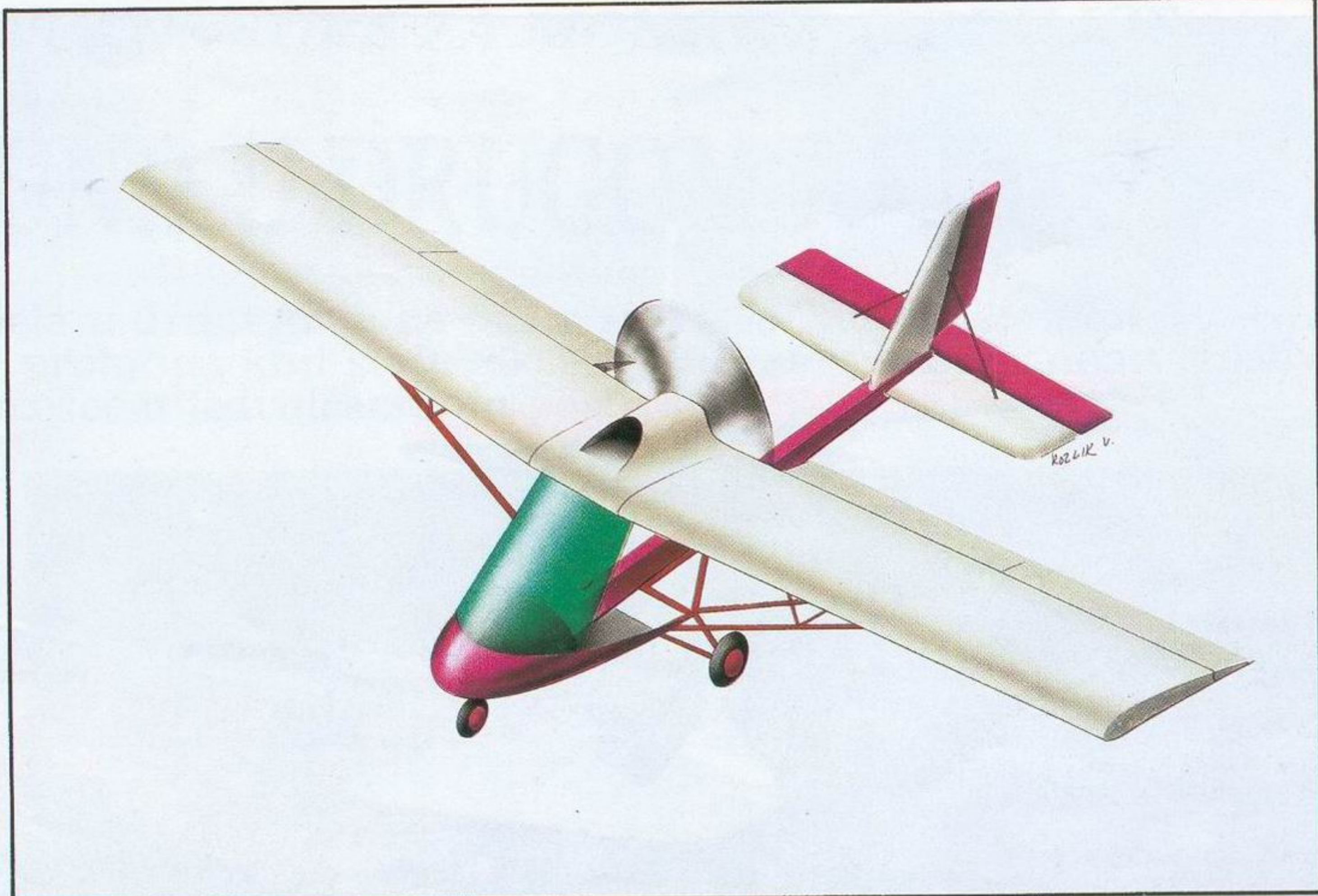
Prvenac »Pan-aera« — dvosed projektovan prema propisima »FAR 23« u svakom detalju pokazuje visoku stručnost graditelja.
