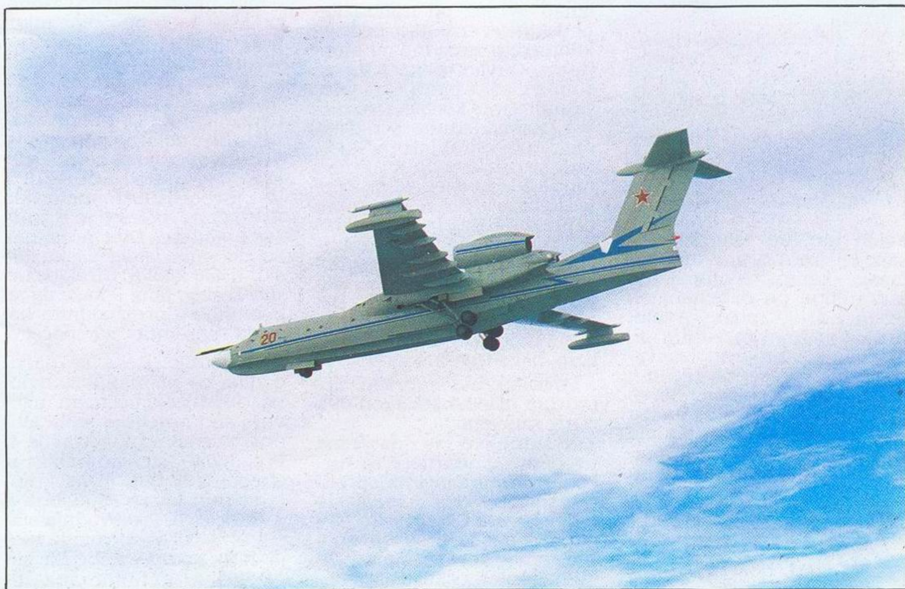
A-40 prilikom provere izvlačenja stajnog trupa u letu
