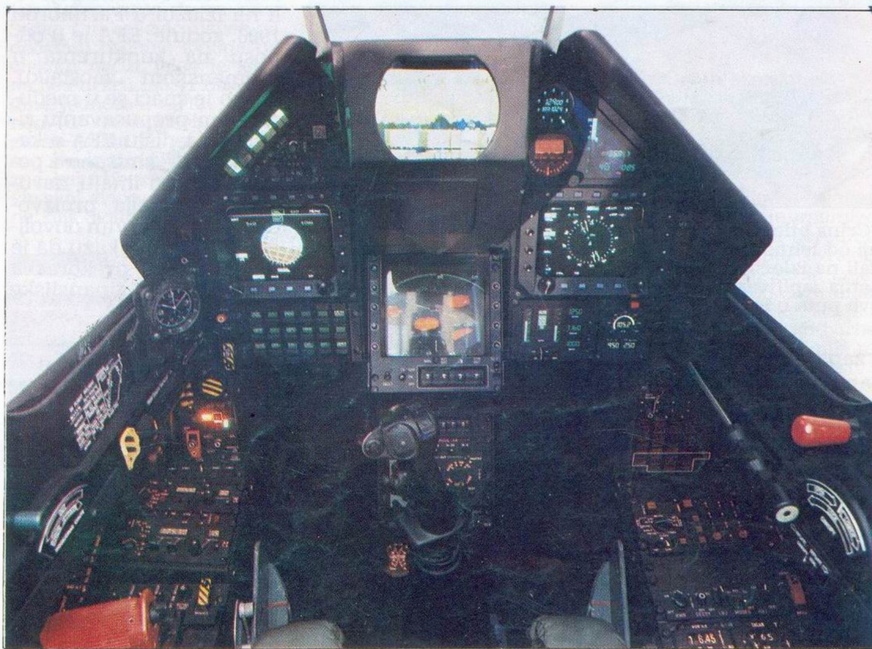
»Miradž 2000-5« se po pilotskoj kabini sa CRT displejima ne razlikuje od aviona sledeće, IV generacije. HOTAS komandni sistem je omogućio da minimalan broj prekidača ostane na tabli, tako da je gotovo ukinuta potreba pilota da skida ruke sa komandne palice i komande gasa
