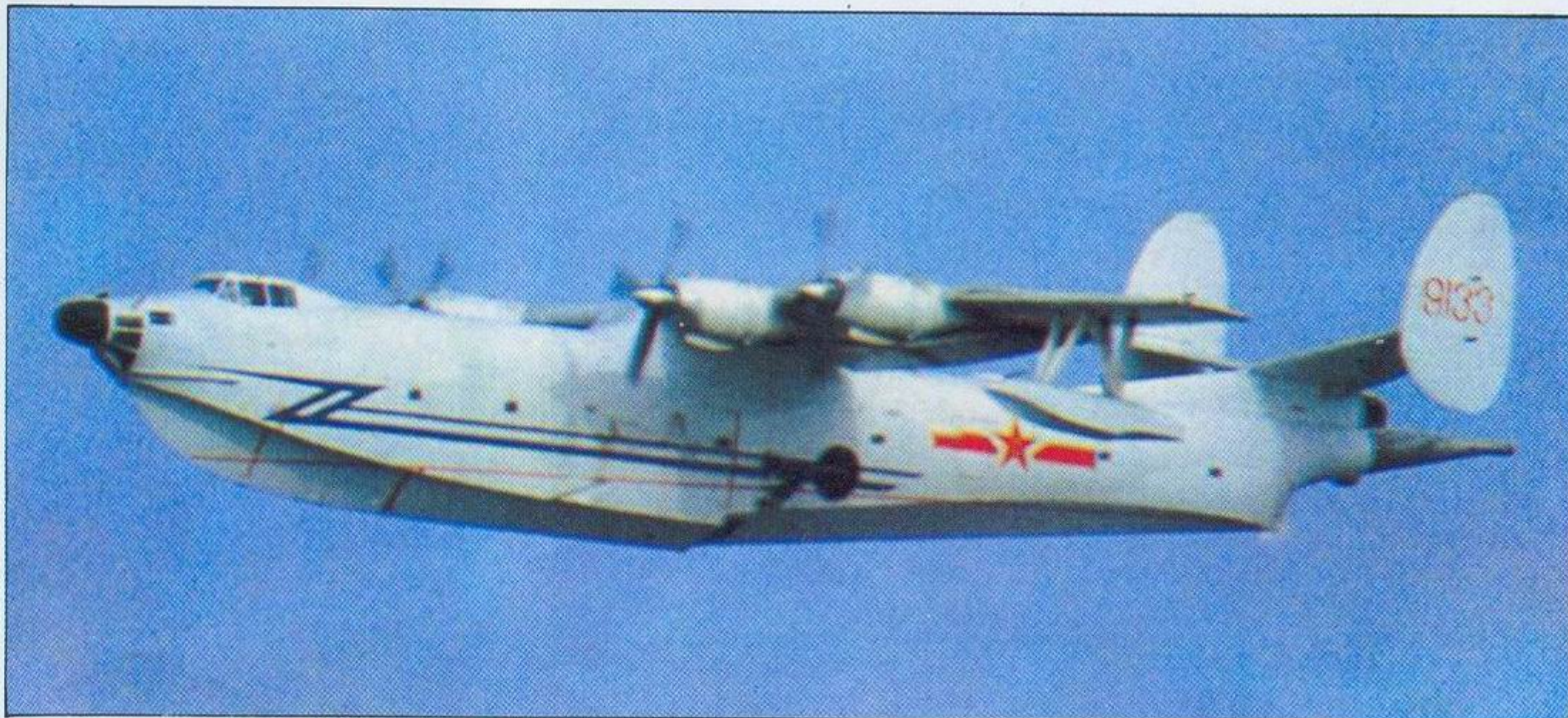
Kineski SH-5, originalno razvijen za borbu protiv požara. Maksimalna poletna težina oko 40 tona. Nepoznat broj do sada proizvedenih.
