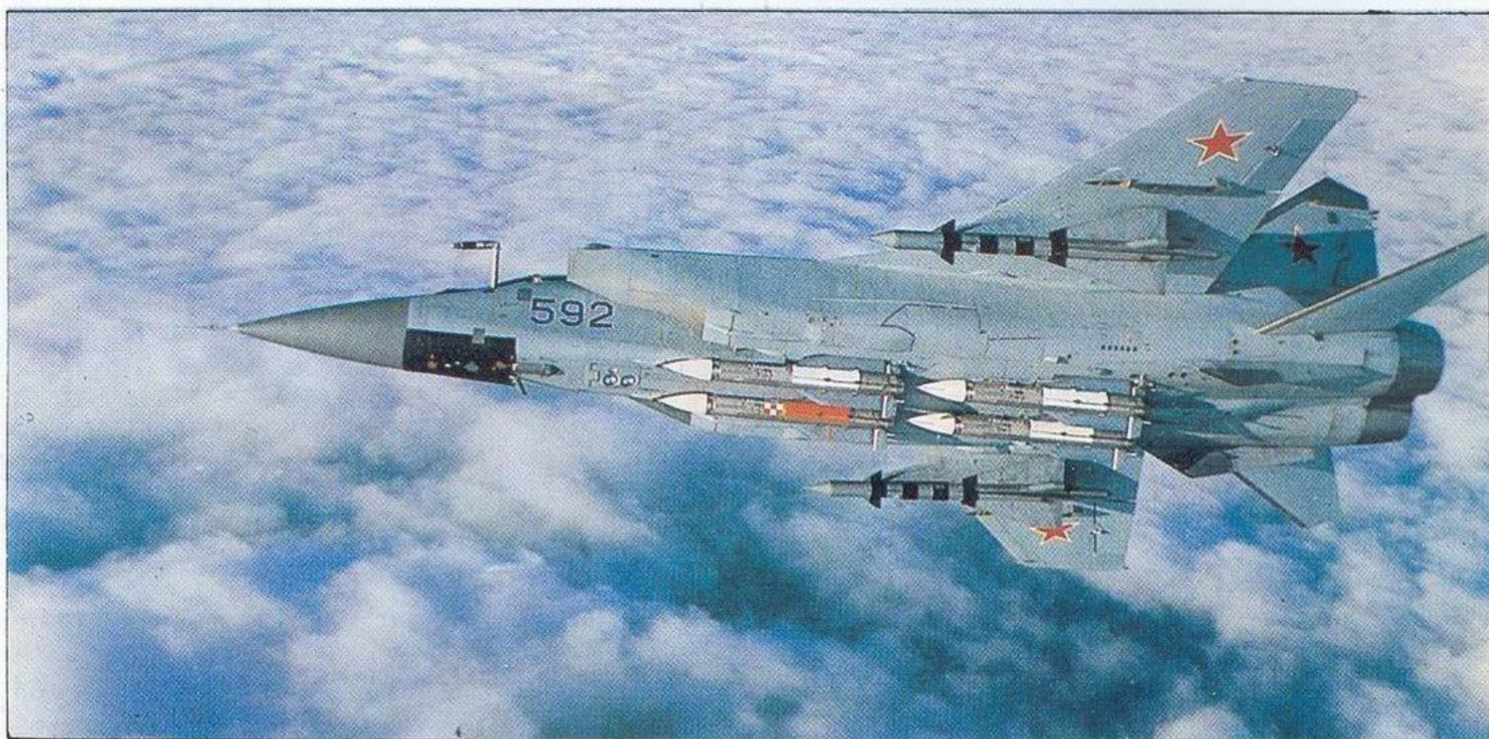
Mig-31 je težak kao »karavela«, leti brzinom od 3000 km/h na visini od 17.5 km, nosi do 10 raketa
