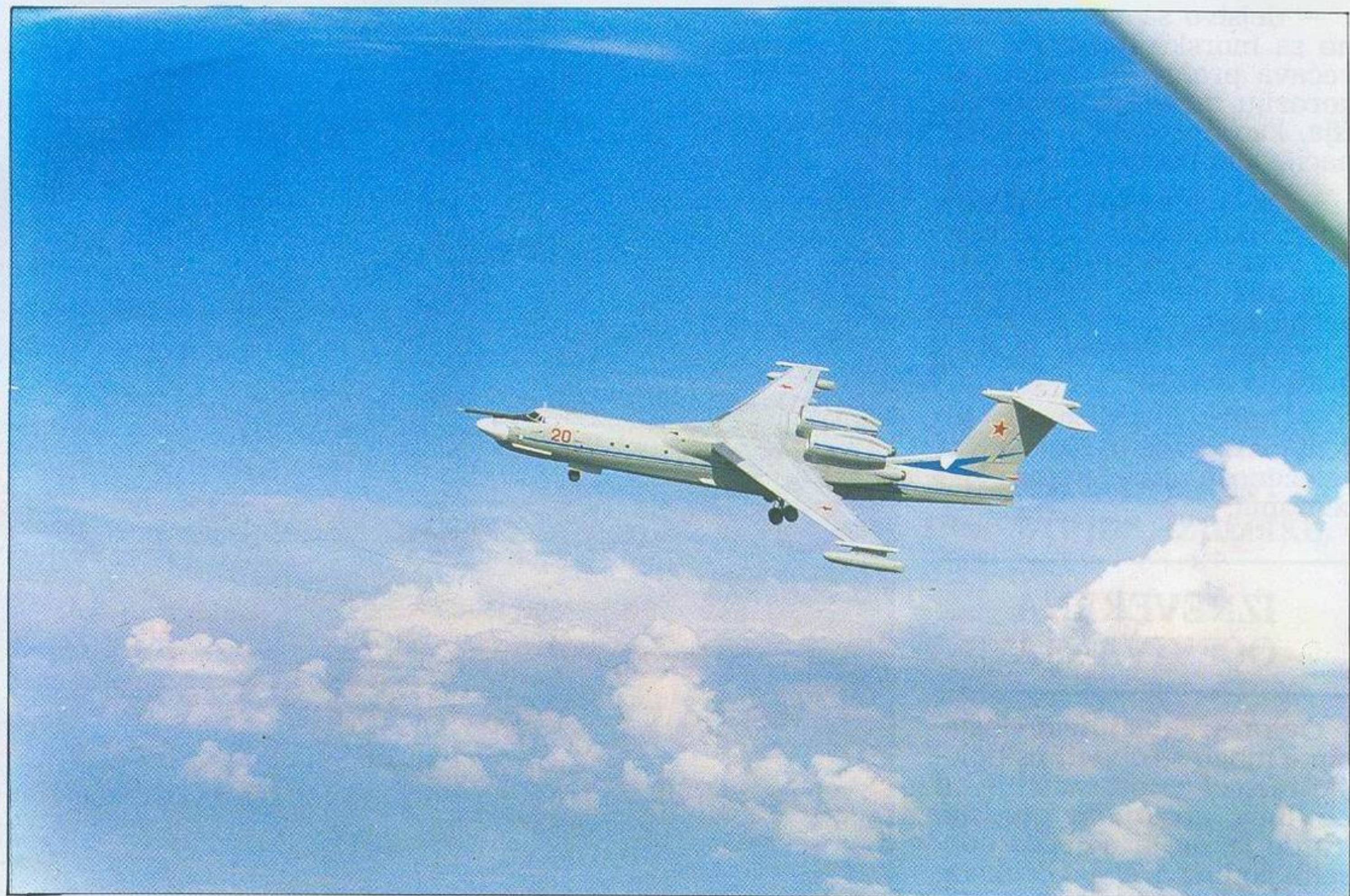
Beriev A-40. Jedini mlazni amfibijski avion na svetu. Prvi put prikazan svetskoj javnosti juna ove godine na izložbi u Parizu. Osnovna namena: protivpodmornička borba. Sovjetski Savez razmišlja o prodaji na Zapadu u varijanti za prevoz putnika.
