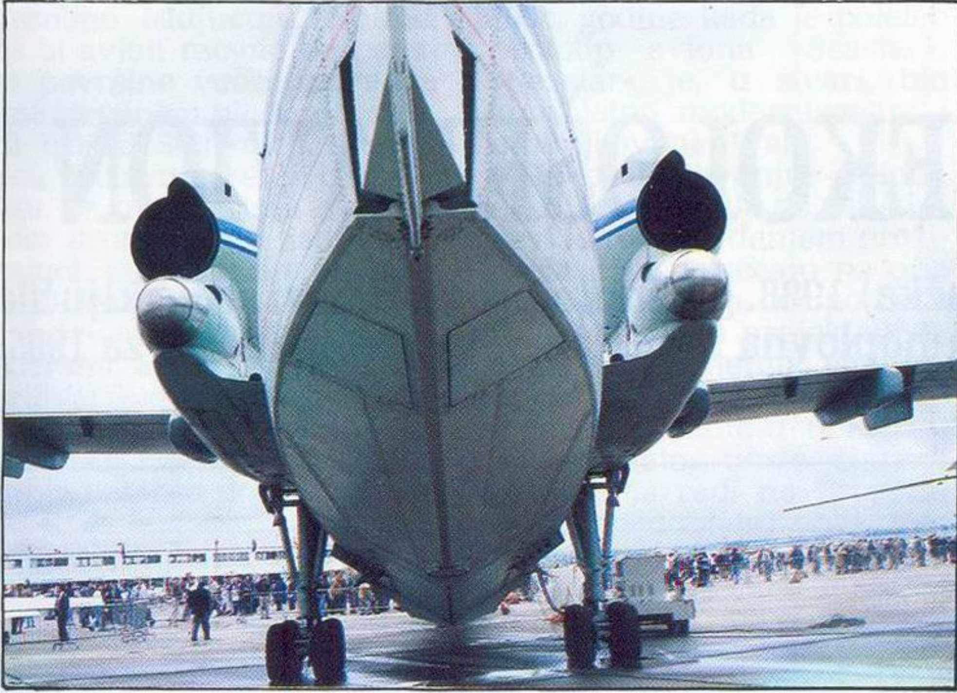
Položaj vrata na trupu, daleko iza centra težišta pokazuje da avion nije projektovan za izbacivanje vode na požare, već za opremu za otkrivanje podmornica, koja se provlači kroz vodu
