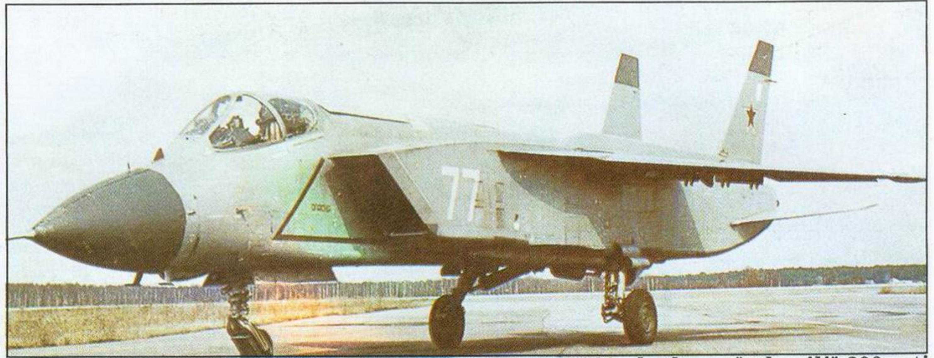
Dva prototipa "jaka-141" su od prvog leta marta 1989. do danas "sakupili" 200 sati leta. Napravljena su još dva prototipa za zemaljska ispitivanja.
