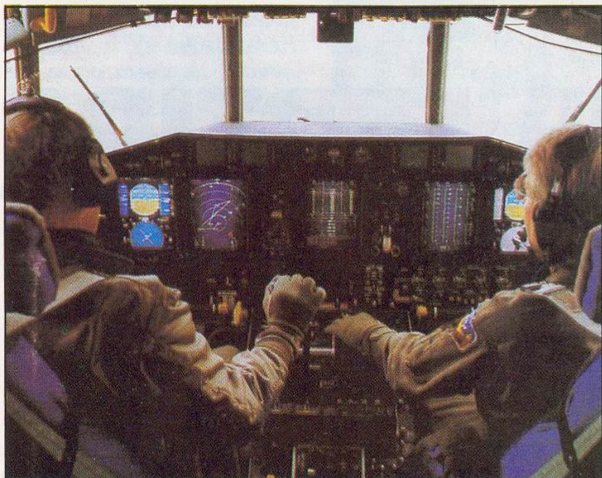
Instrumentalna tabla "herkulesa" sa šest displeja (levo) i stara (desno)
