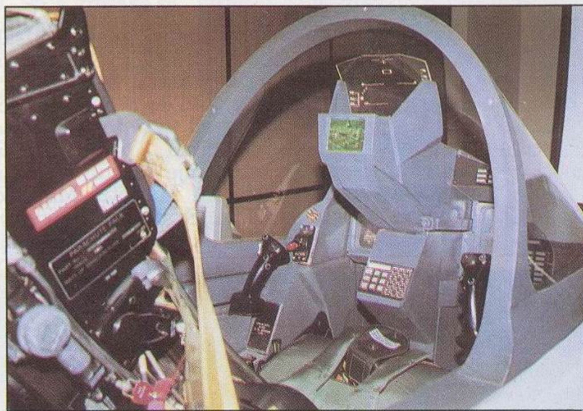
Funkcionalni model pilotske kabine lovačkog aviona IV generacije izradjen u VTI Žarkovo
