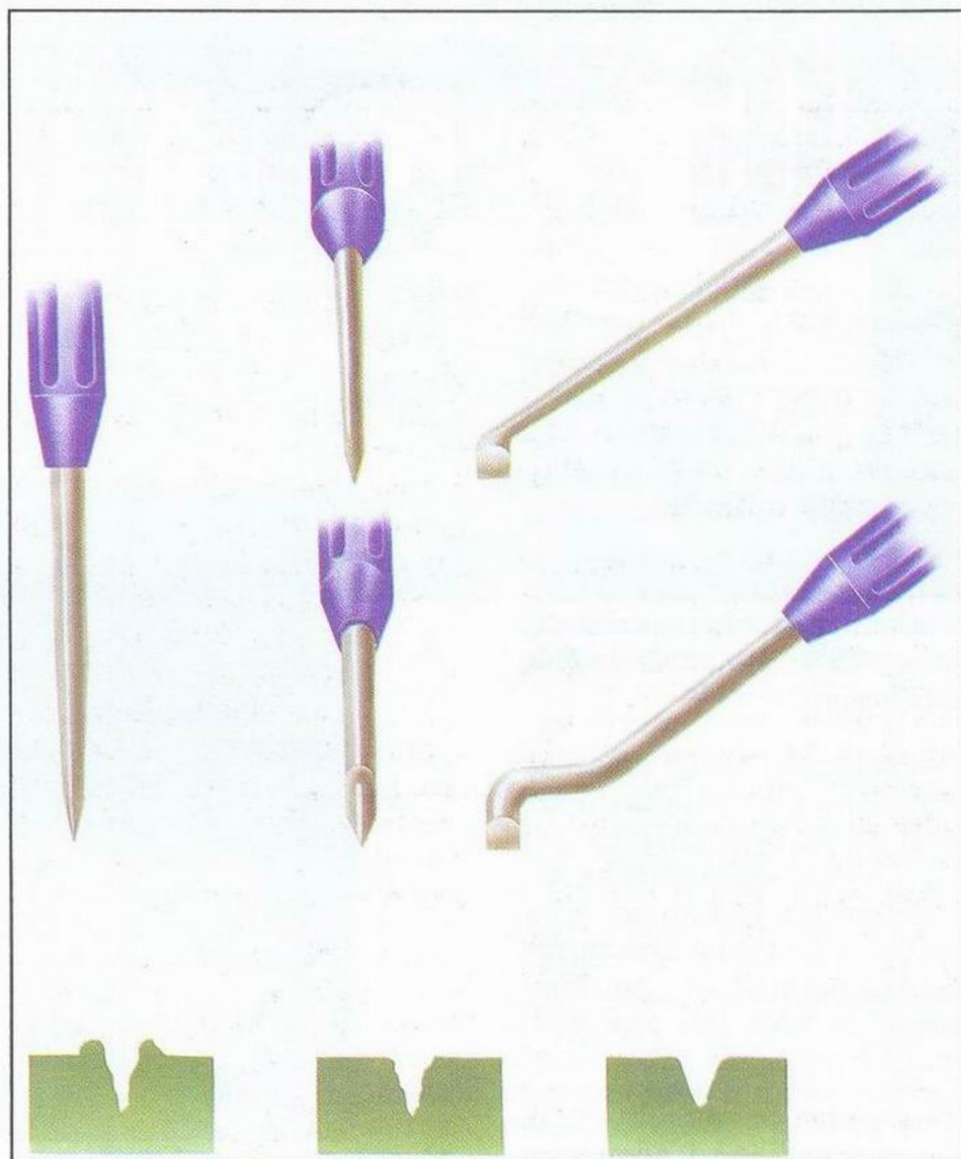
Oblici alata (šabera) za urezivanje linija panela na oplati makete
