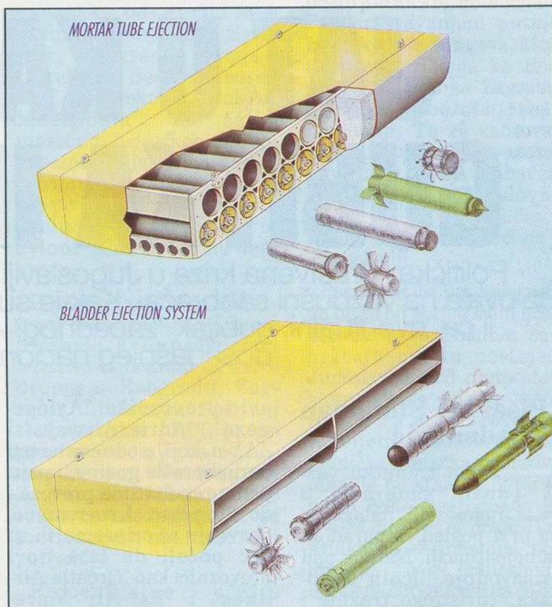
Slika 5. Ubojni sadržaj najnovije italijanske bombe/rakete "skajšark". Na gornjoj slici: punjenje sa bočnim, a dole sa podužnim izbacivanjem
