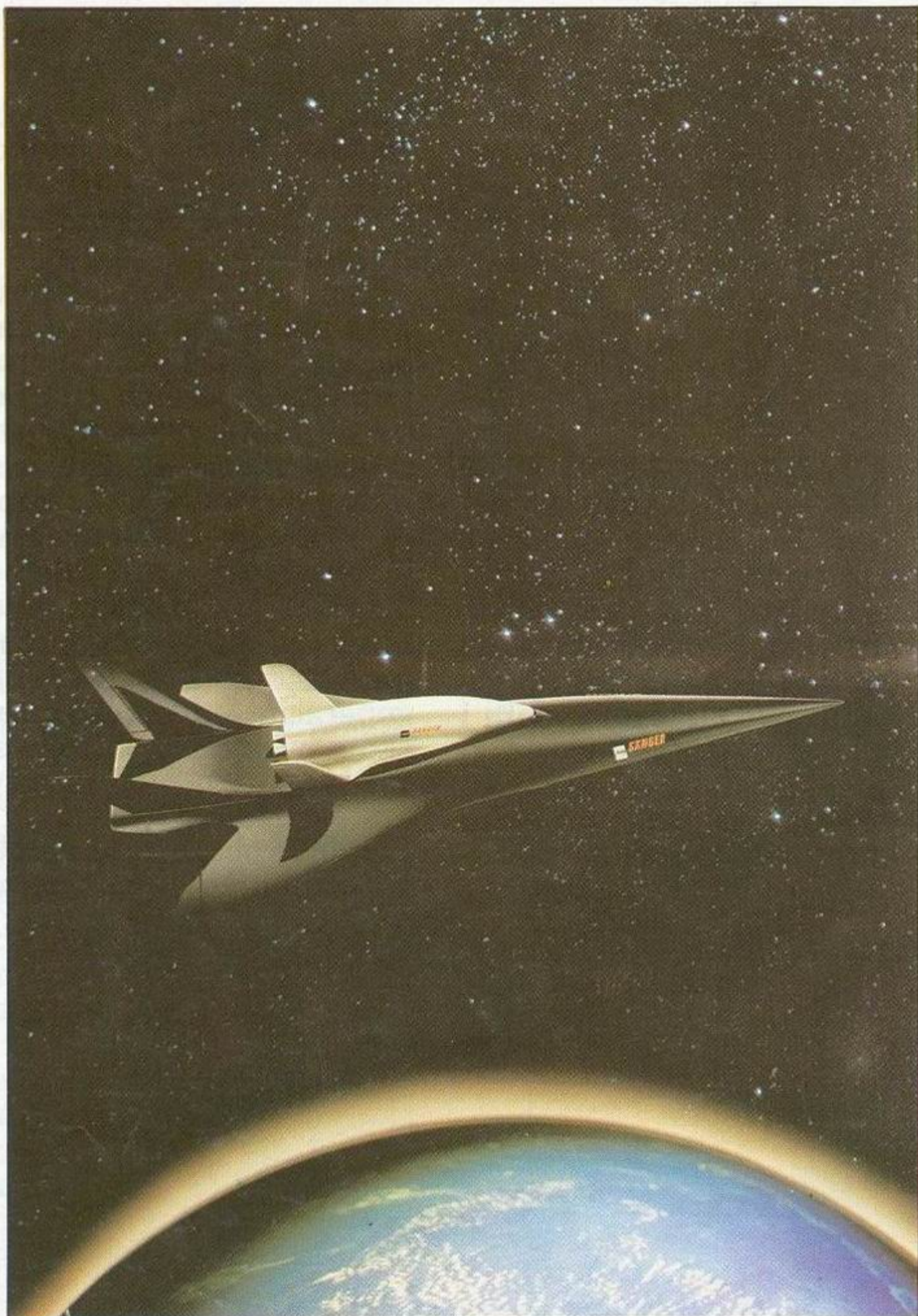
Dvostepeni kosmički transportni sistem "Zanger" će se višekratno upotrebljavati. Moći će da poleće i sleće na veće postojeće aerodrome.
