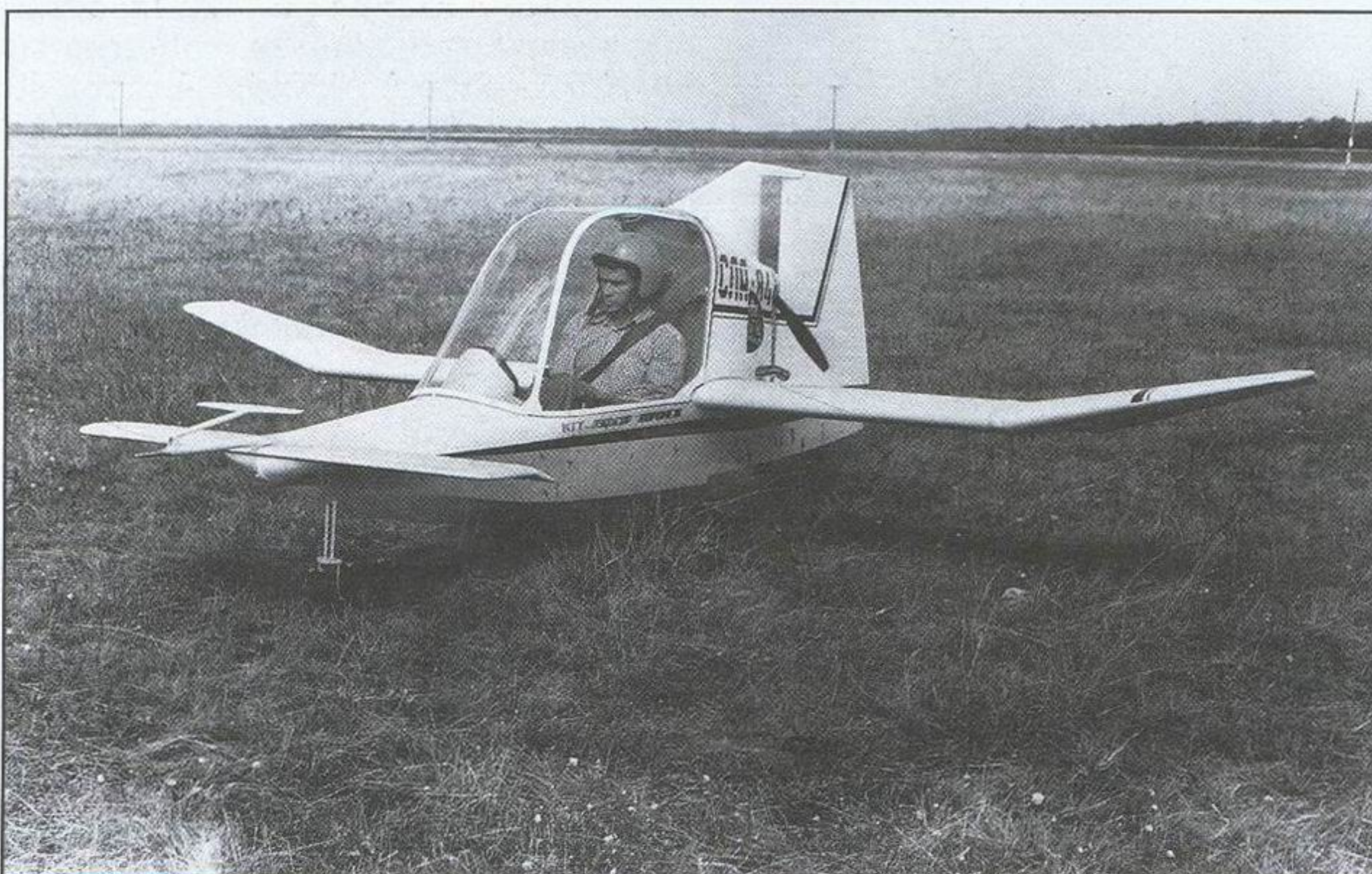
Ekperimentalna amfibija "Čirok" ima neuobičajenu "patka" konfiguraciju sa potisnom elisom. Projektovani su je i izgradili u samograditeljskom klubu "Pulsar" u Voronježu
