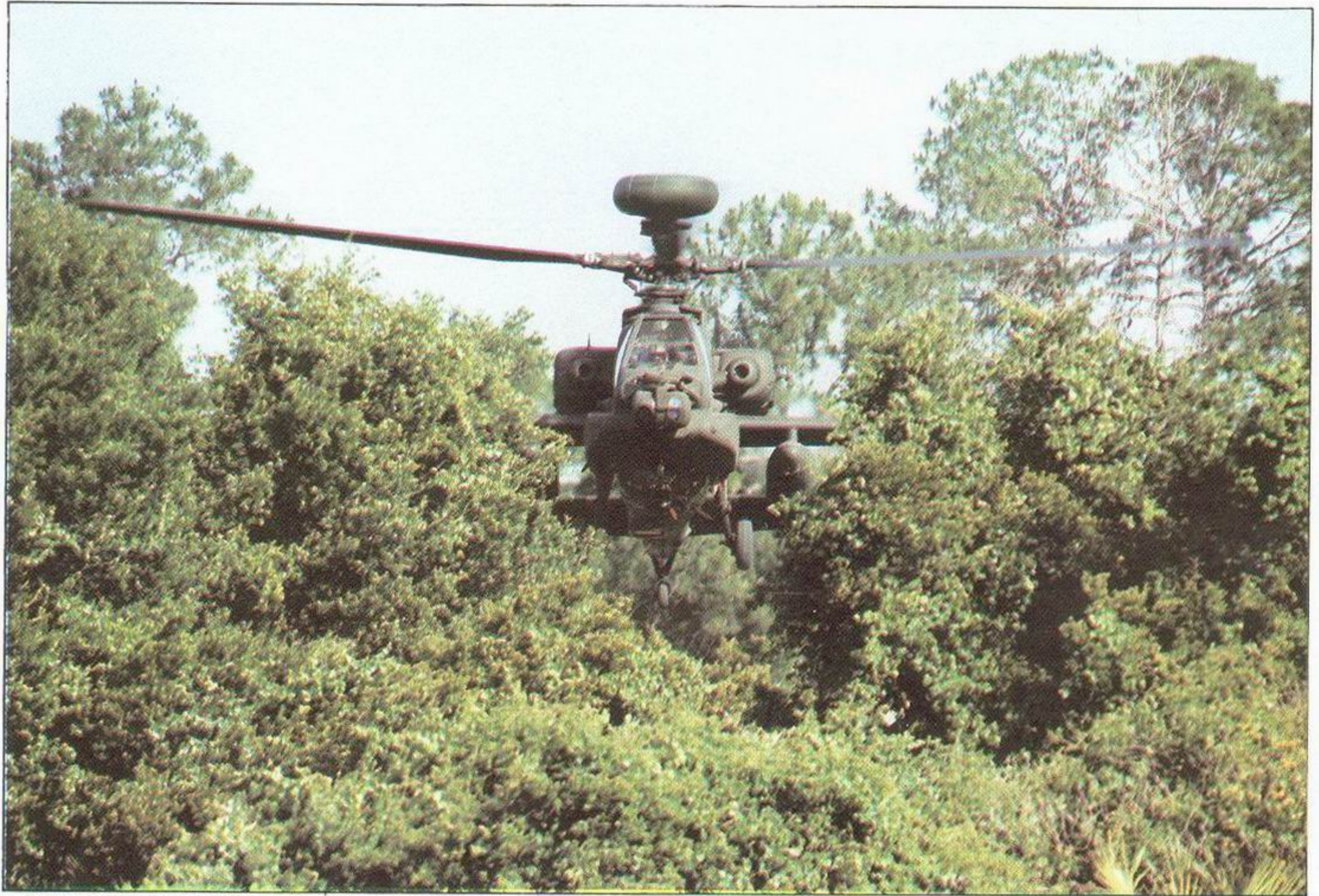
AH-64C "apač" sa "longbow" radarom iznad rotora i TADS/PNVS sistemom u nosu
