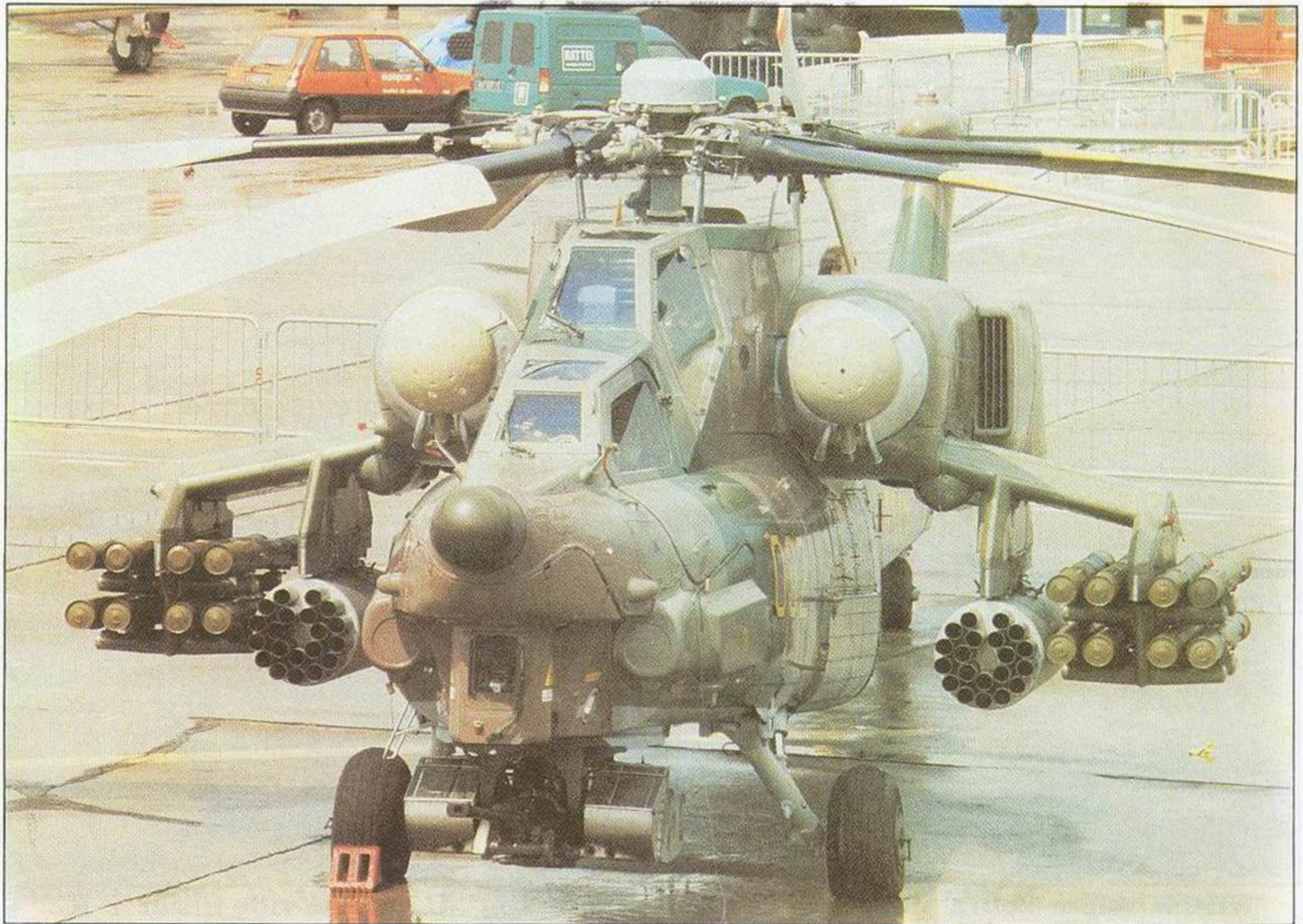
Šesnaest raketa "šturm-S" na helikopteru Mi-28, uz dva sačasta lansera nevodnih raketa. Radom na nosu helikoptera (tamno ispupčenje) krije antenu radio-predajnika za vođenje. Ispod nosa se vidi optoelektronski uređaj za noćno osmatranje i poluautomatsko vođenje.
