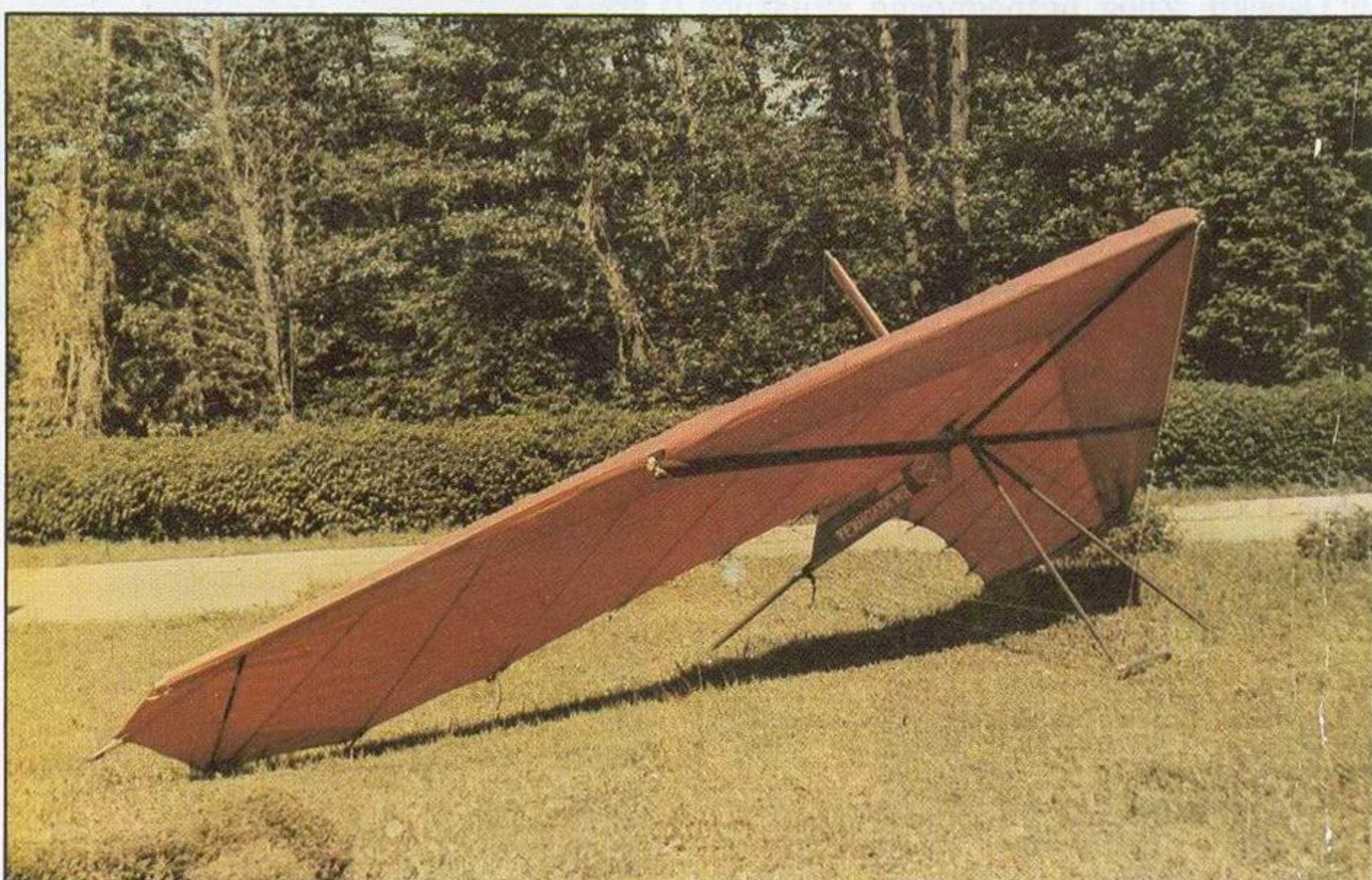
Projektovanjem i proizvodnjom UL letelica se u SSSR bave čak i instituti. Na slici je zmaj kompletno napravljen od kompozita na bazi karbona u Institutu "ONPO Tehnologija" kod Moskve.
