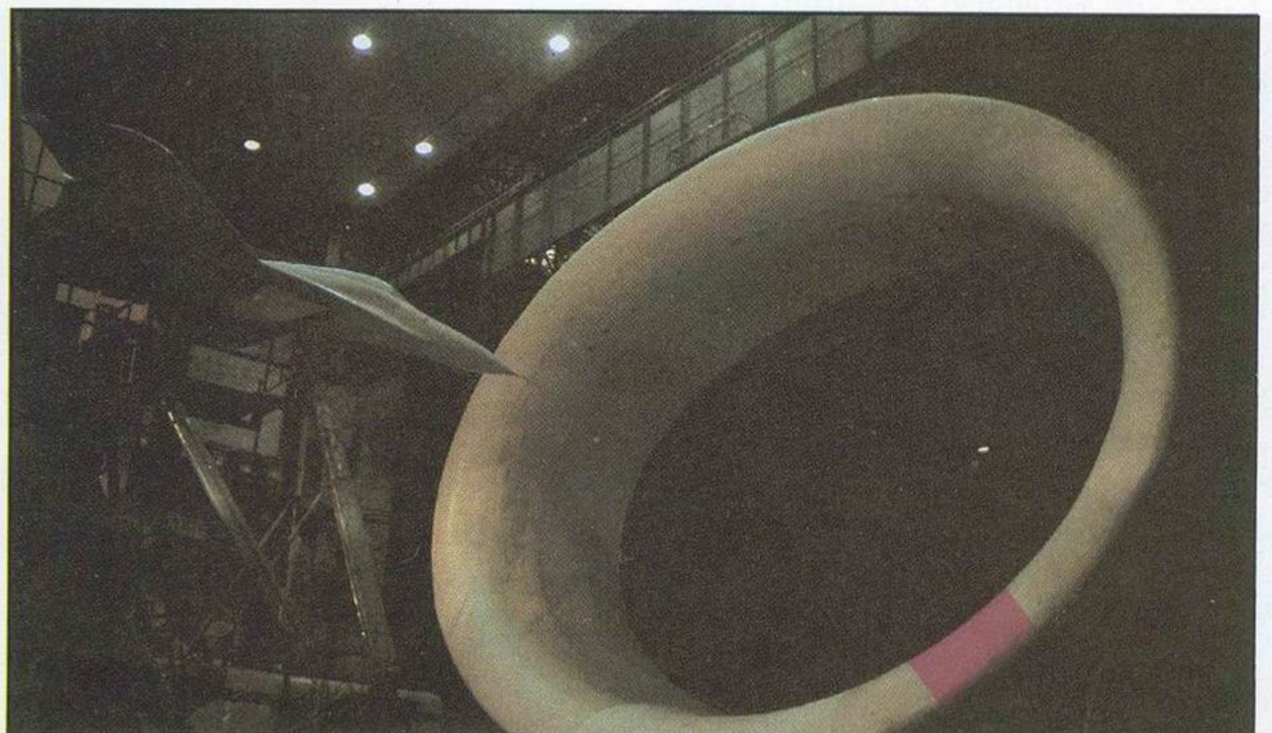
U "CAGI"-ju se nalazi najveći aerotunel u svetu. Na slici je T-101, jedan od 18 tunela u Institutu, u kojem je upravo u toku ispitivanje lovca MiG-29 u prirodnoj veličini na malim brzinama. Radni deo tunela je elipsa dimenzija 24 x 14 metara!
