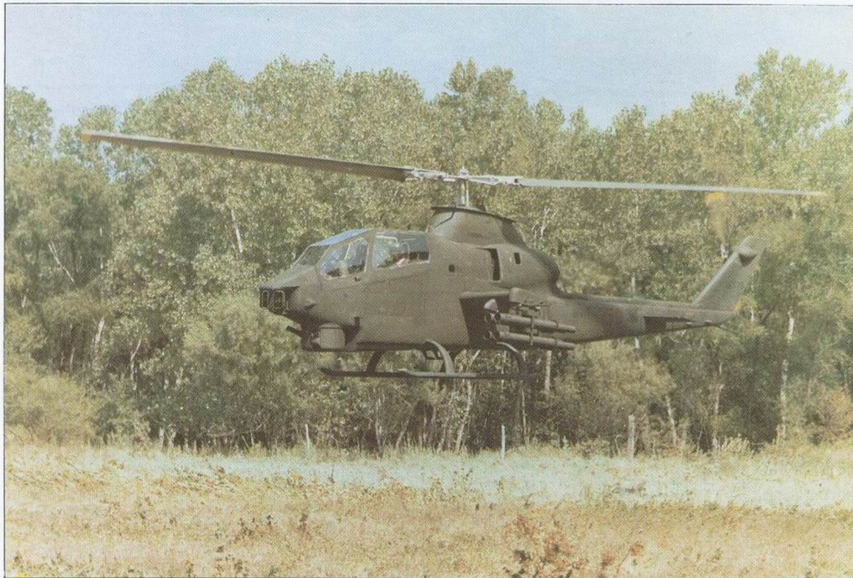
AH-1W "super kobra" naoružan sa osam raketa "tou". U nosu se vide nišan i IC lokator, za vođenje "tou", integrisani sa termovizijskim uređajem za noćno letenje i dejstvo (PNVS)
