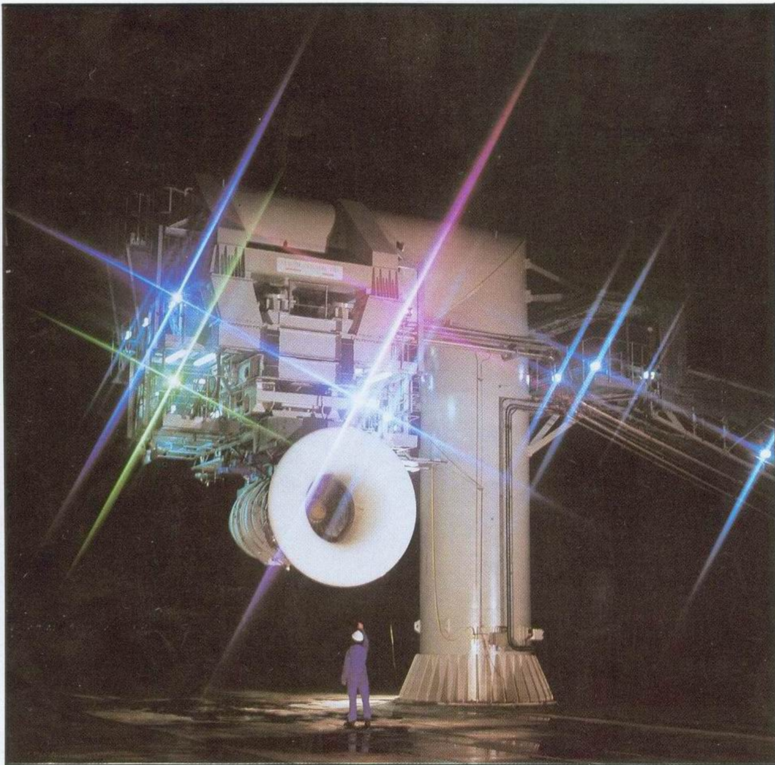
Ispitivanje motora "IAE V2500-A5" na obrtnom probnom stolu kompanije "Rols-Rojs" u Haknalu.
