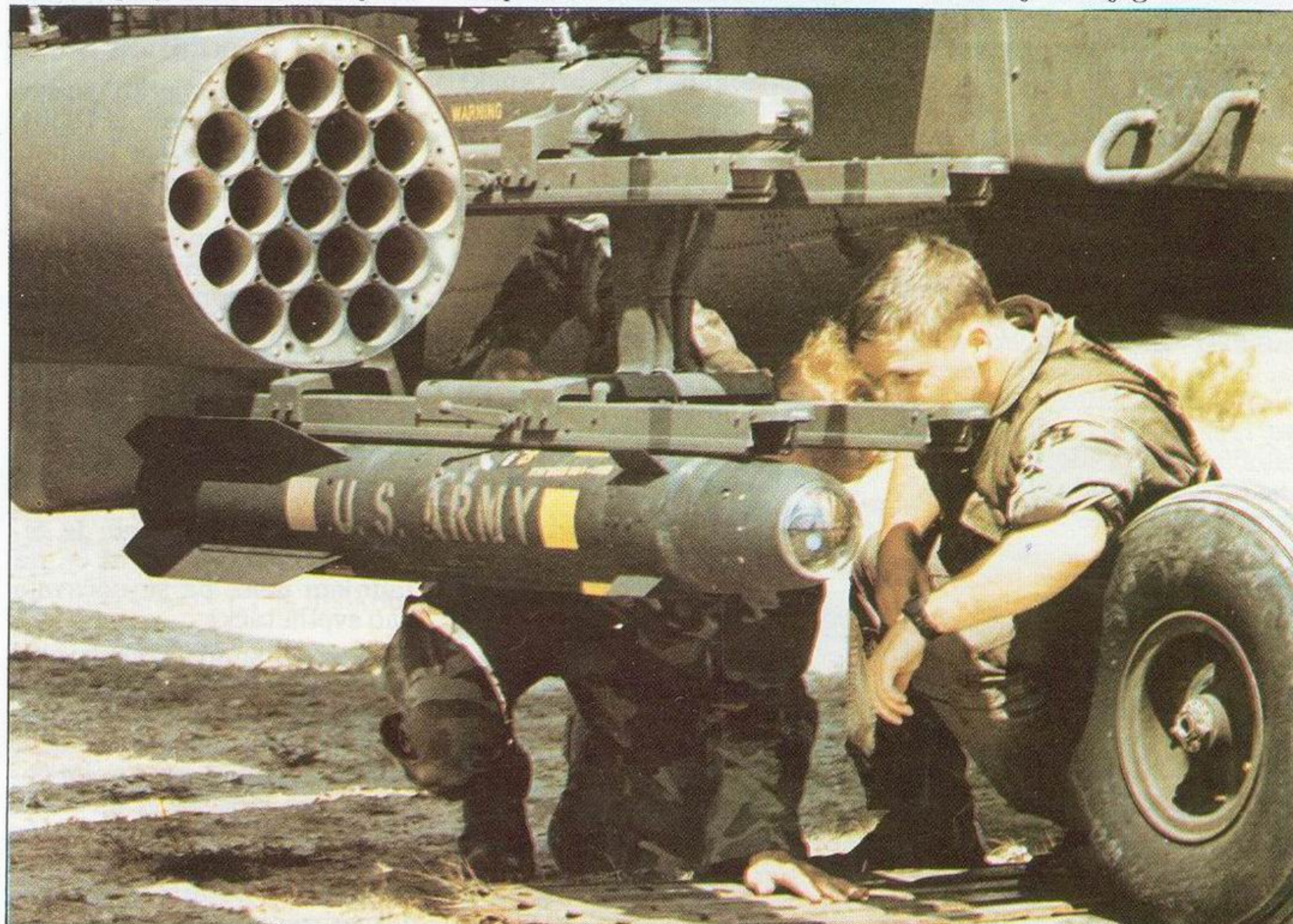
Podvešavanje laserske verzije "helfajer"-a (AGM-114A) na helikopter AH-64 "apač"
