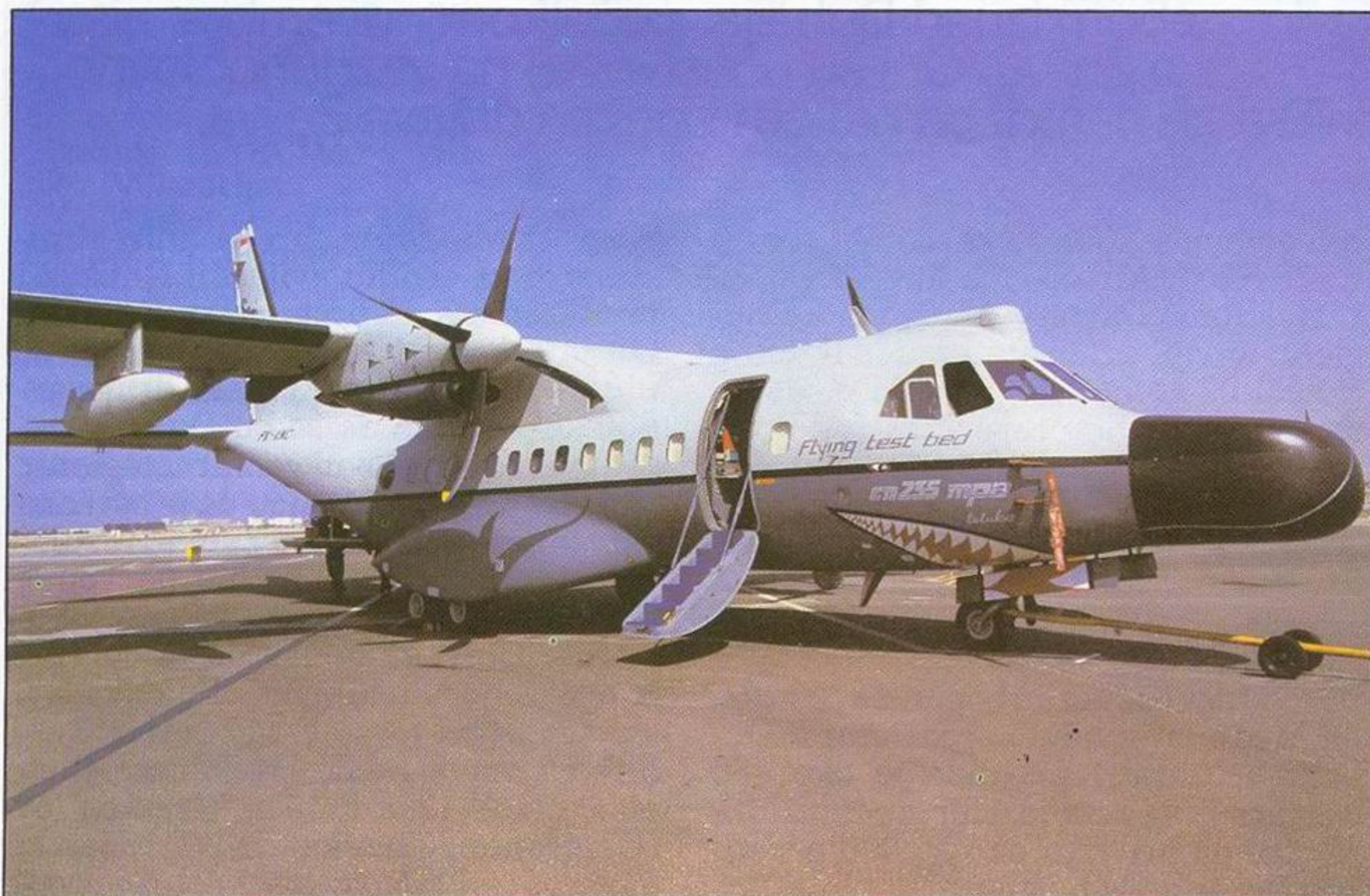
Indonežanski avion za obalsku patrolu IPTN CN-235 opremljen sa dodatnom elektronskom opremom
