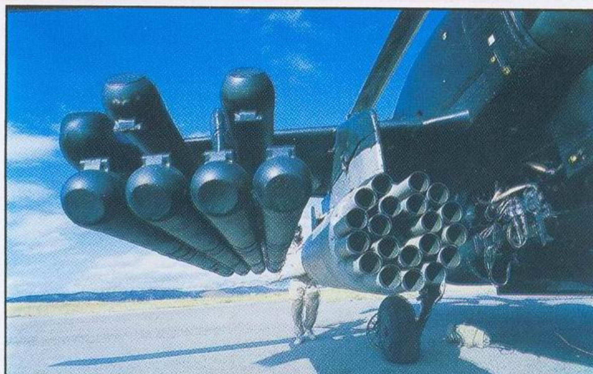
Ka-50 nosi dvanaest protivoklopnih raketa "vihor" i 40 nevođenih raketa kalibra 80 mm na potkrilnim nosačima
