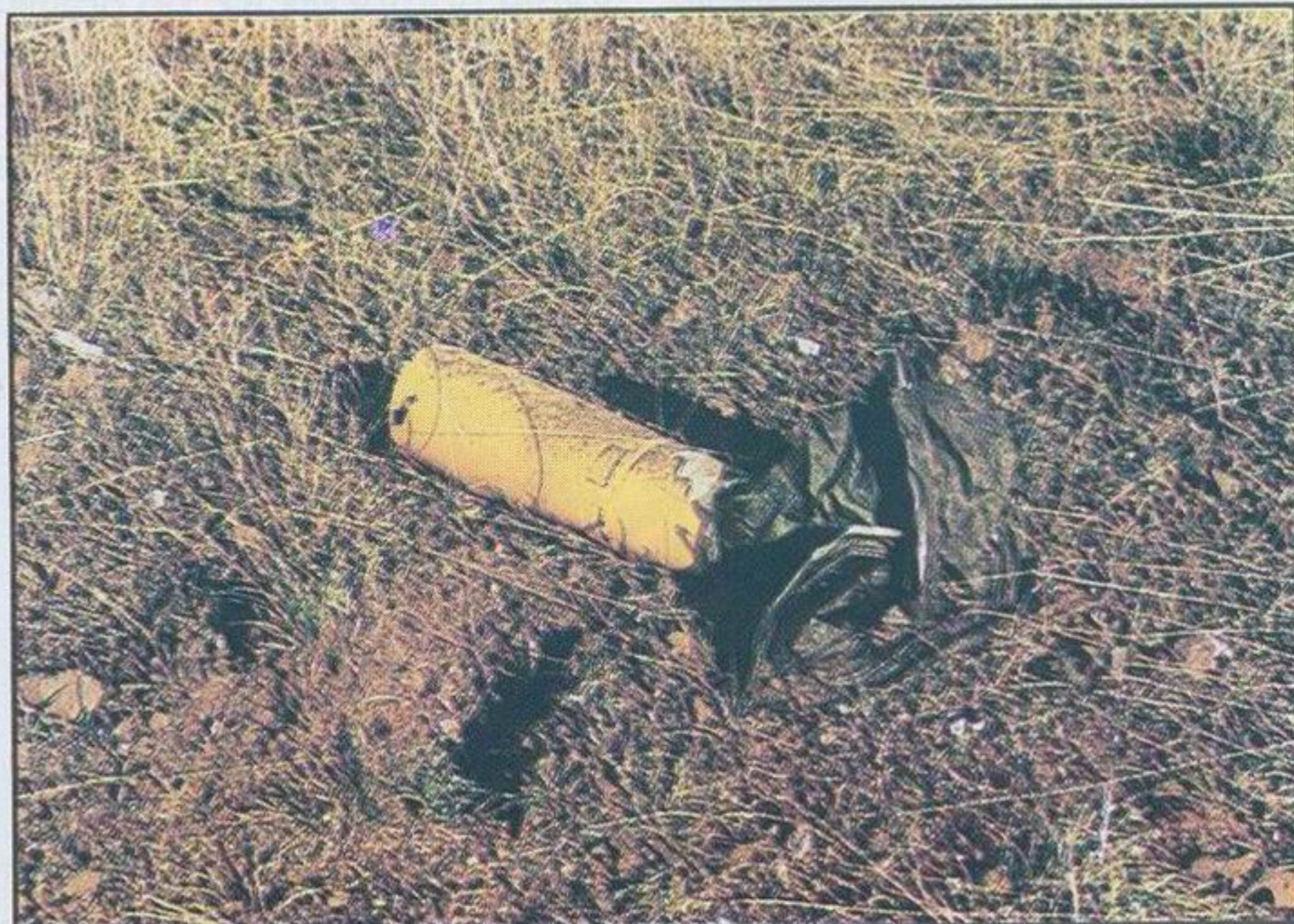
Na položaje PVO aerodroma Udbina padale su kasetne bombe američke proizvodnje CBU-87/B koje su punjene sa 202 bombice BLU-97 A/B. Na fotografiji je jedna od bombica koje su zatajile. (foto: Aleksandar Radić)
