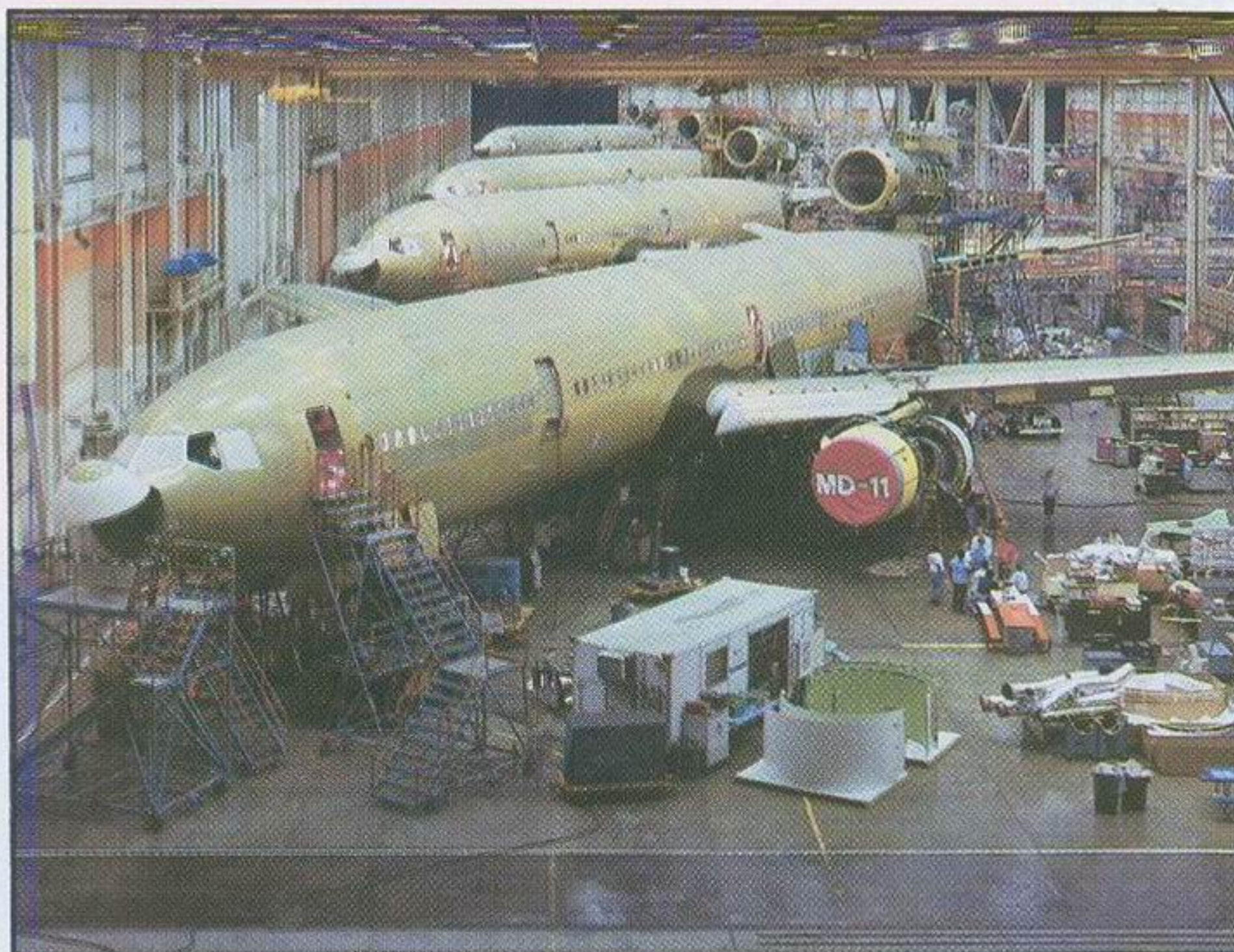
Proizvodnja linija tromotornog MD-11 u fabrici "Daglas erkraft kompani" (Douglas Aircraft Co.) u Long Biču na kojoj će se sklapati i dvomotorna verzija putničkog aviona klase 300 putnika, doleta 13000 kilometara.
