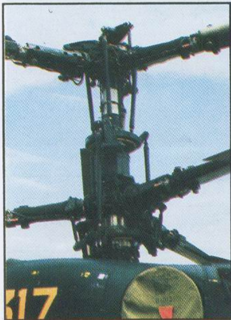
U slučaju opasnosti krakovi koaksijalnog rotora odbacuju se piropatronama pre aktiviranja raketnih motora za izbacivanje sedišta (Foto: A. Demek)
