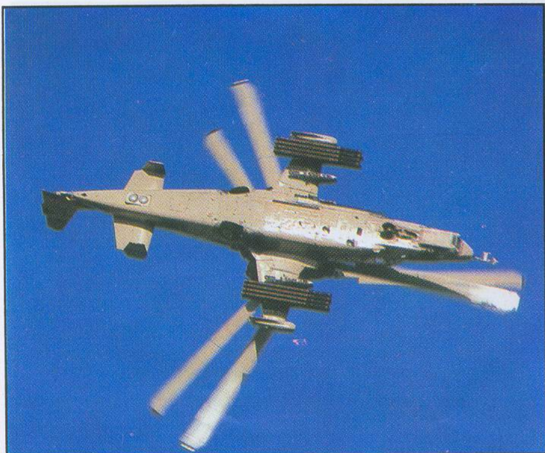
Koaksijalni rotor obezbeđuje izvanredne manevarske mogućnosti (Foto: K. Tokunaga)
