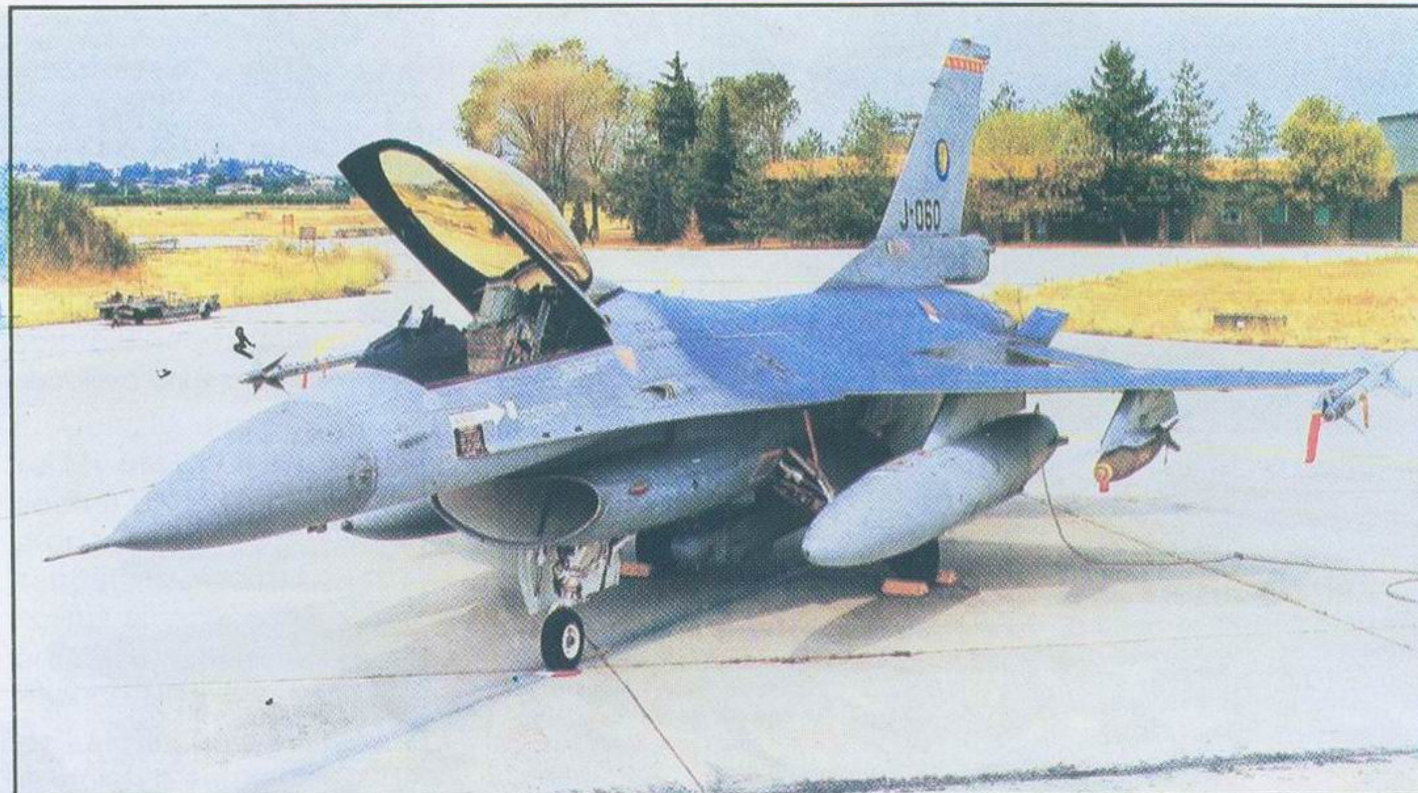
F-16A holandskog ratnog vazduhoplovstva na stajnici aerodroma Vilafranka u Italiji. Ispod krila su podvešene dve avio-bombe Mk.82 mase 227 kg. Na centralnom podtrupnom nosaču je kontejner sa opremom a elektronska dejstva ALQ-131. Za vazдушnu borbu na krajevima krila nosi dve rakete AIM-9L.
