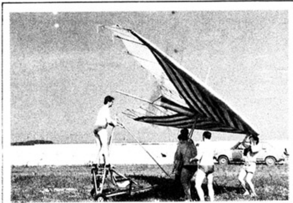
Slika 58 — Montaža krila na tricikl.
