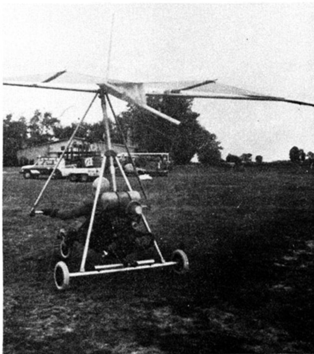
Slika 63 — Dok se zčaj vozi po tlu vide se da su krajevi dve late vezani za vrh jarbola čime se postiže sigurnost protiv obrušavanja.
