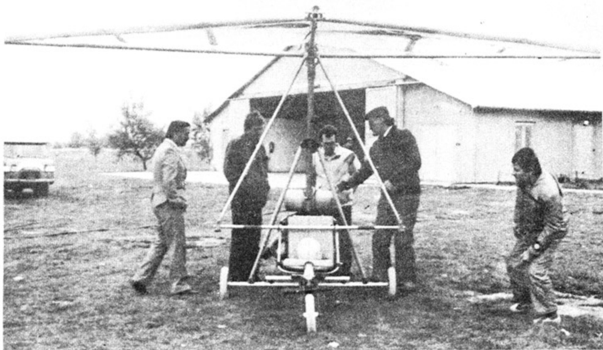
Slika 64 — Tipičan motorni zmaj (pogled sprede).
