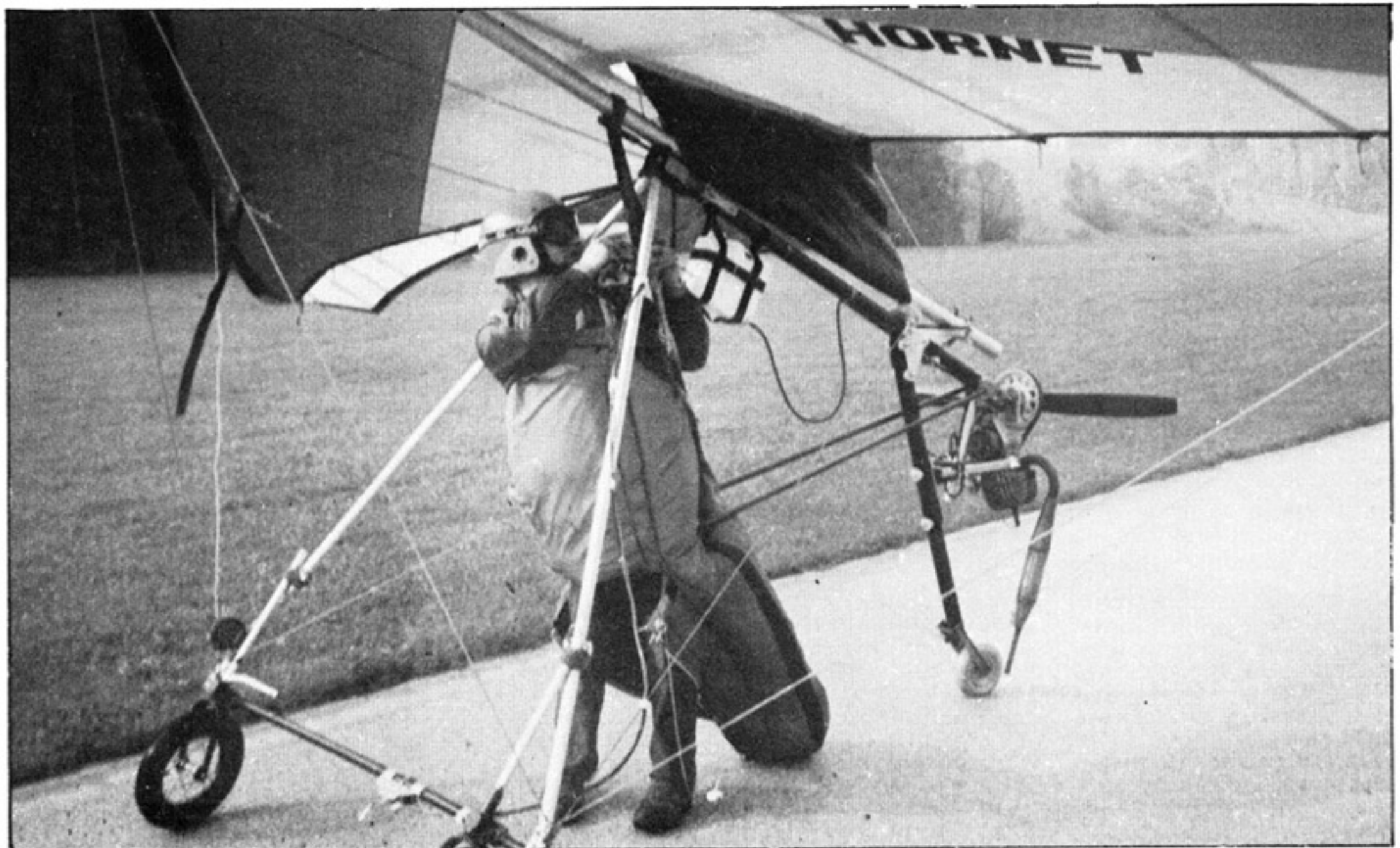
Slika 51 - Umesto na sedištu pilot je u vreći čime se postiže izvrsna aerodinamičnost.
