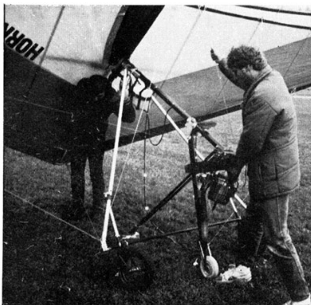
Slika 52 — Pogled na minimalca sa zadnje strane prilikom podizanja motorskog sklopa uz kobilicnu cev.
