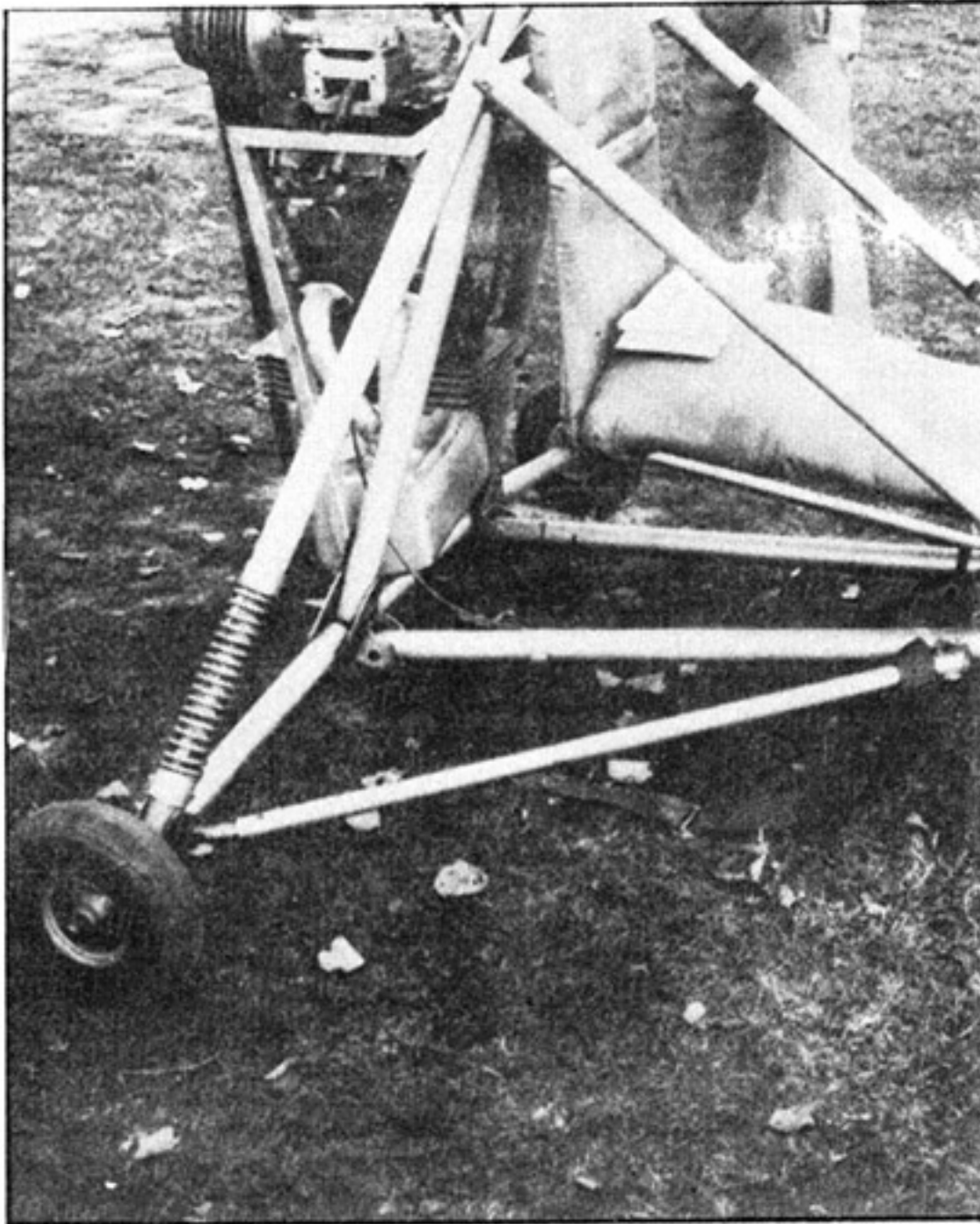
Slika 13 — Amortizer od motocikla može poslužiti i na zmaju.
