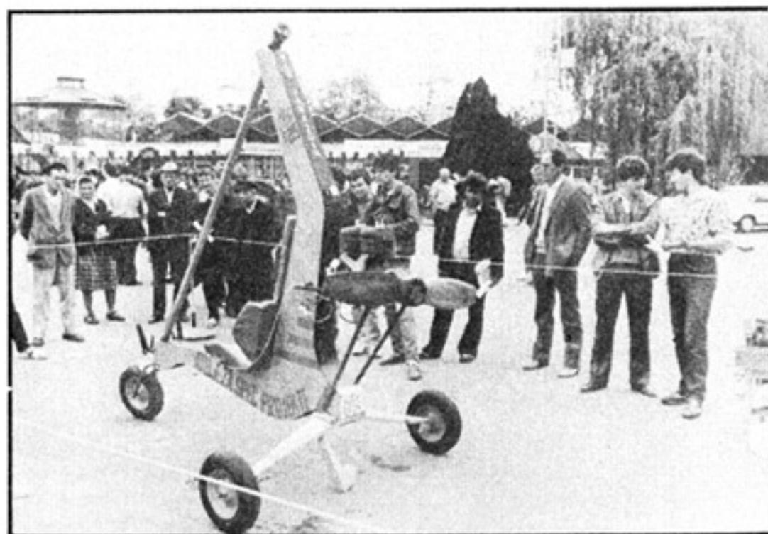
Slika 19 — Drveni luk ojačan poliesterom i sajlom — konstrukcija Atelje za specijalne projekte.
