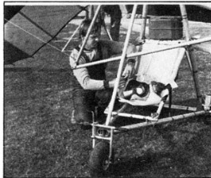
Slika 45 — Prednji točak sa pedalom »gasa«, viljuška slična našoj i uz desnu ivicu slike vidi se kako je montiran akumulator od 6 V kojim se baterijski sistem za paljenje snabdeva strujom.
