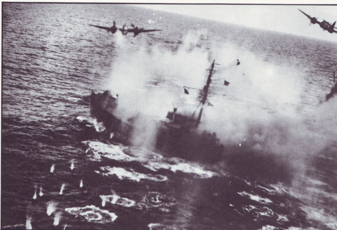
Levo: Bristol bofajteri sa raketama i topovima napadaju neprijateljsku ladu. Ti avioni, koji su bili izuzetno uspešni daljinski lovci upotrebljavani protiv brodova, potpuno su promenili dotadašnju taktiku u borbama aviona s brodovima. Krajem 1943. godine su rakete potpuno potisnule avionska torpeda, koja su bila dotle glavno oružje protiv neoklopljenih brodova.
