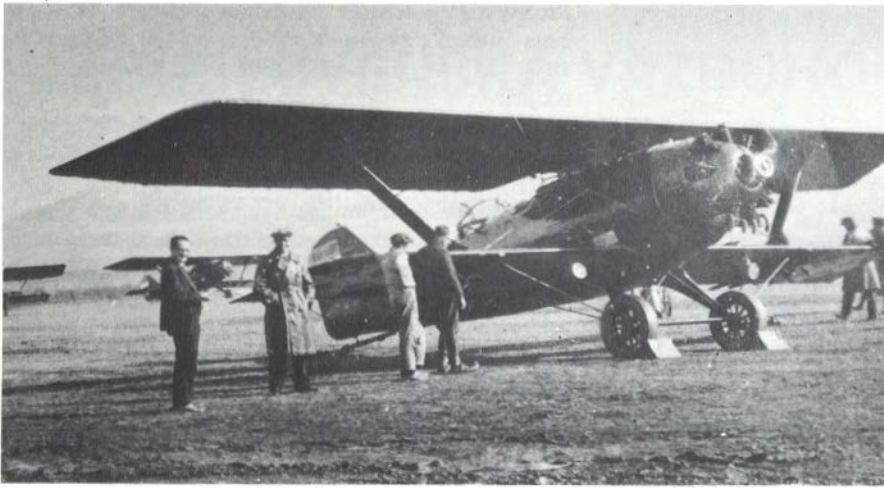
Gore: Jedan od bregea 19 sa motorom jupiter pred probni let na aerodromu fabrike aviona u Kraljevu. U ovoj fabrici je od 1927. do 1933. proizvedeno ukupno 425 aviona brege 19 različitih verzija.
