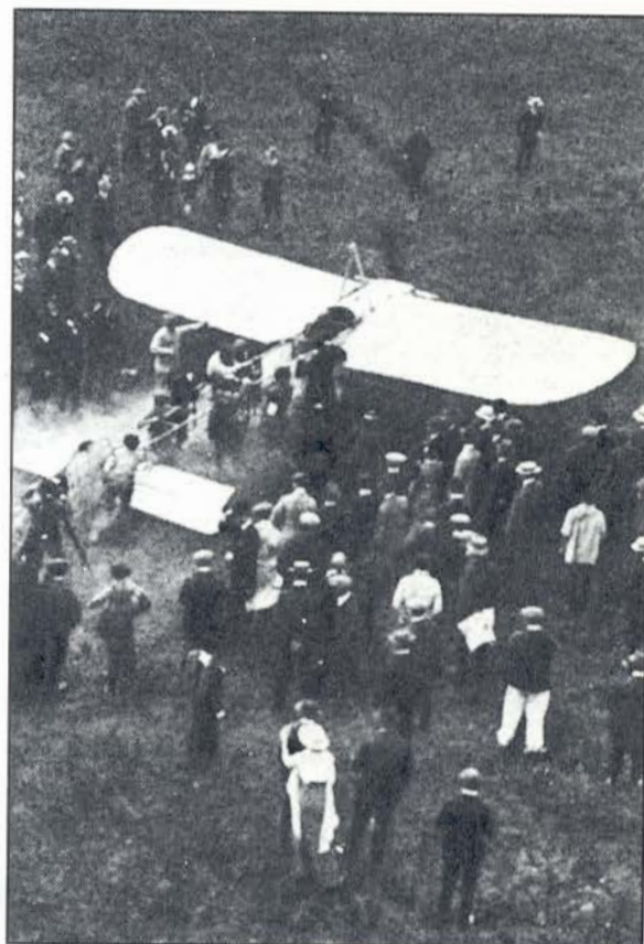
Gore: Pegu u sedištu svog aviona blerio XI godine 1913. Piramida za učvršćivanje je viša no kod uobičajenih aviona toga tipa, a upornice su dvostruke kako bi krila postala dovoljno čvrsta za akrobacije.
