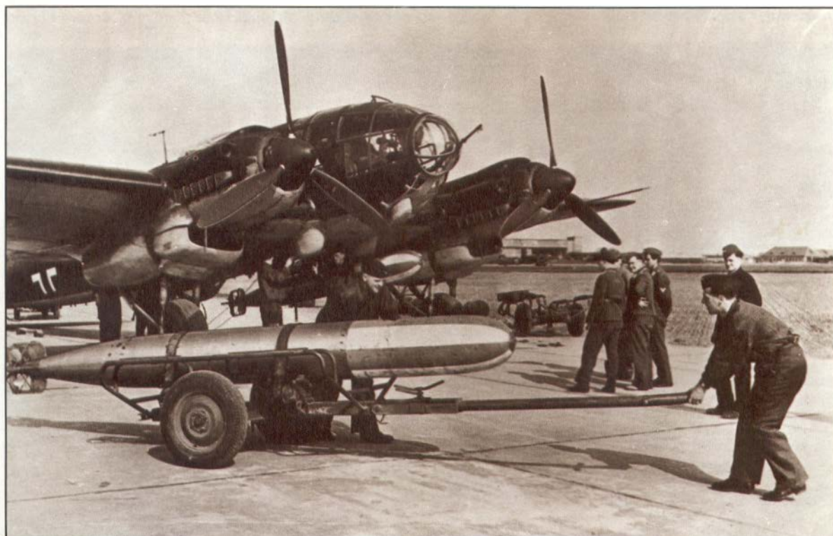
Desno: Postavljanje torpeda pod He-111 H-6 . Ova varijanta je mogla da ponese po dva torpeda, a korišćena je i u 11 grupi 26. bombarderskog puka tokom leta 1942. u borbama protiv britanskih konvoja u Severnom moru.
