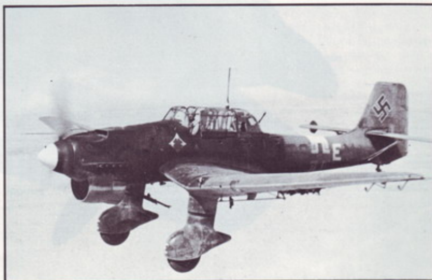
Dole: Ju-87 B-2 je imao snažniji motor od verzije B-1 , bolji hladnjak, široke krake elise, što je sve dalo poboljšane performanse.
