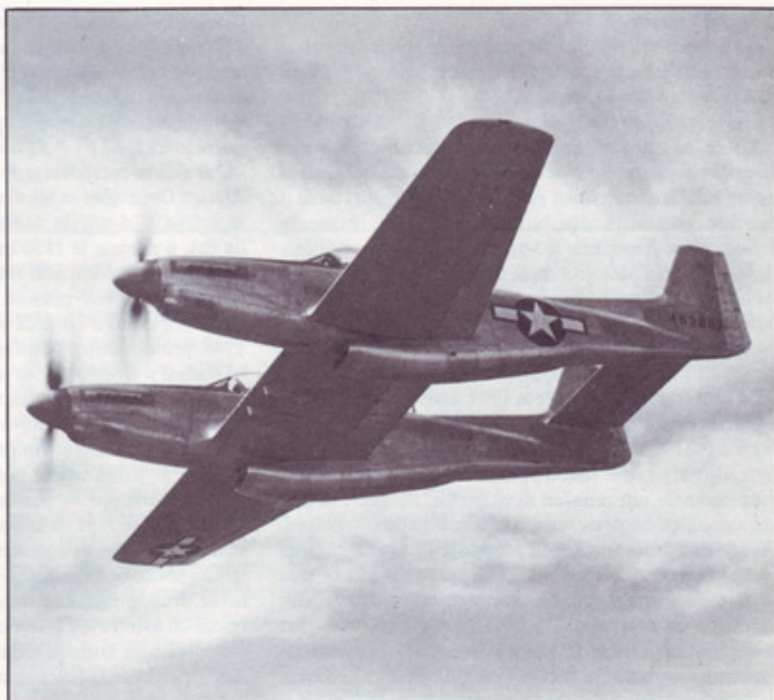
Gore: P-82 twin mastang , lovac velikog doleta, nastao spajanjem dva kodifikovana trupa P-51 H, sa novim centralnim delom krila i repnim površinama. Na slici je prikazan drugi prototip tog neobičnog aviona.
