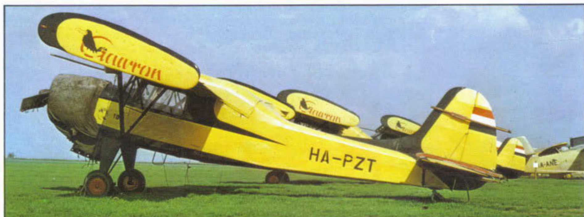
Desno: Primerak PZL-101 gavron koji je pripadao madarskoj avijaciji. Ovaj avion je inspirisan sovjetskim Jak-12M i dugi niz godina bio je izrađivan u fabricama PZL.
