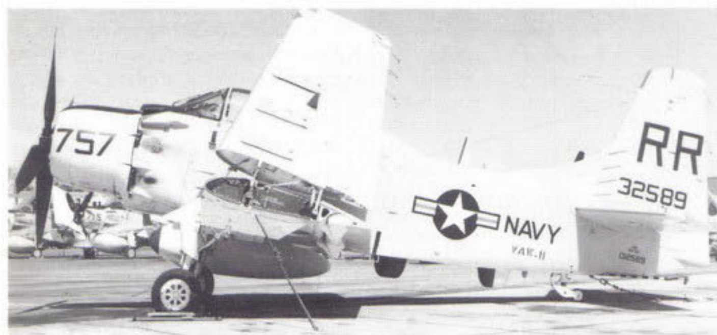
Levo: Avion AD-5Q, varijanta skajrejdera opremljena radarom.
