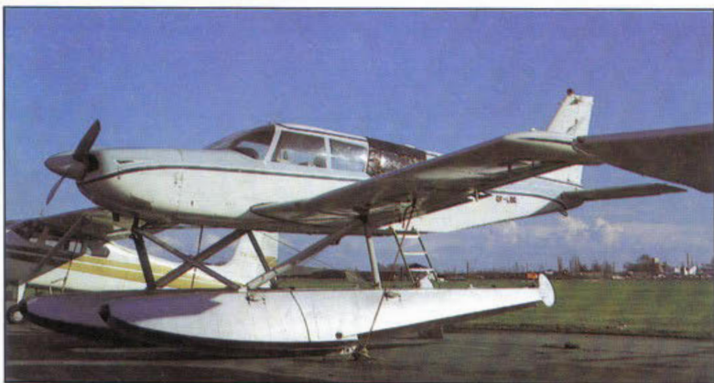
Gore: PA-32 čiroki siks je prvi put poleteo 1963. Bio je »razvučena« verzija PA-28, a onda je i sam započeo seriju lakih aviona lens sa T-repom i stajnim trapom na uvlačenje.
