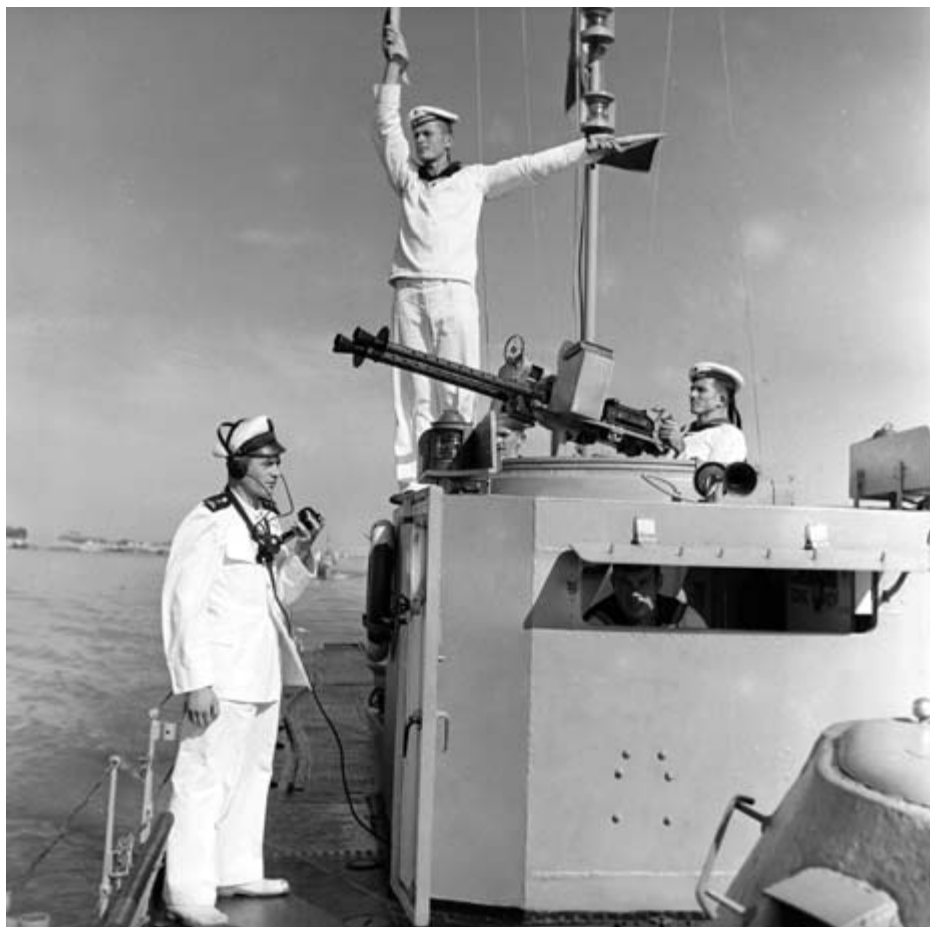
Командни мост речног оклопног чамца са двоцевним противавионским митраљезом 12,7 мм
