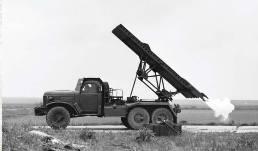
Лансирање ракете М-13УК у улози имитатора циља у ваздушном простору
