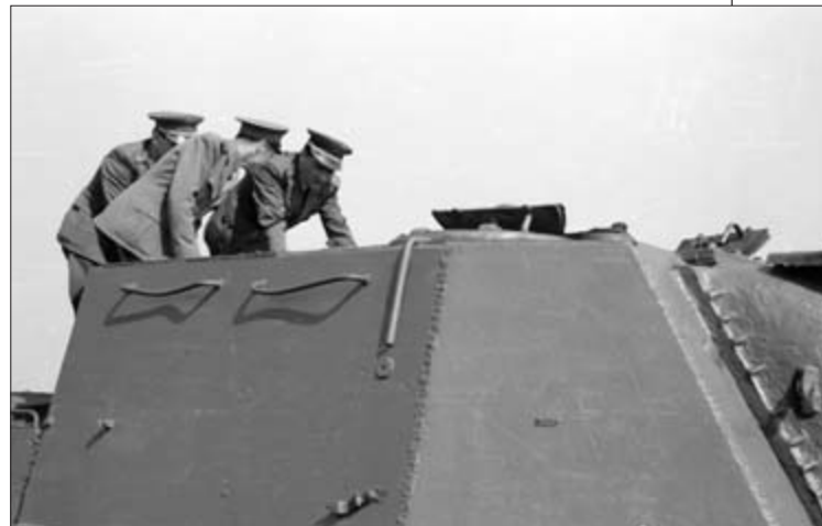
Казамат ИСУ-152 у којем се нашло места за хаубицу 152 мм и 20 дводелних метака
