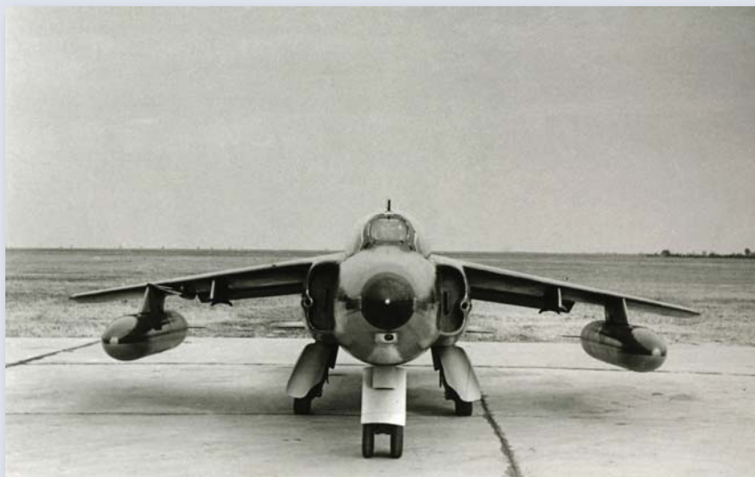
Због скромних 613,3 kg горива у унутрашњим резервоарима, „неш“ је гошћиво увек носио подвесне резервоаре са додатних 479 kg горива (ВОЦ)
