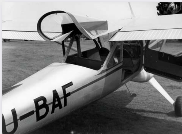
Кабина „утве-56“ и свих каснијих модела прилагођена је за укрцавање носила преко великих задњих вратића (фото ВОЦ)
