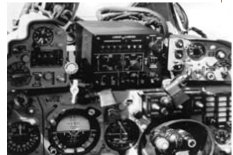
Управљачка кутија система LORAP у кабини авиона МиГ-21МФ
