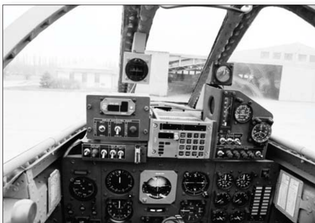
Уређаји навигацијског система ИИЈ-22М: рачунар-показивач DCAD уграђен у првој пилотској кабини на месту нишана. Лево је уграђен показивач путне брзине и угла заносења GSD (ВОЦ)
