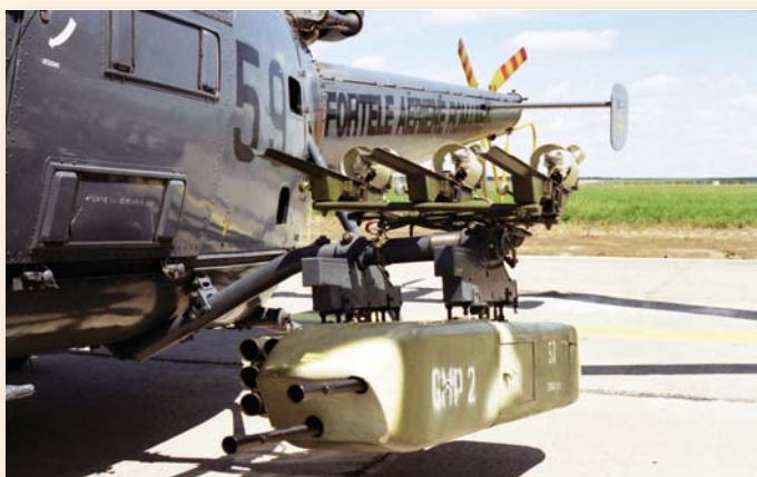
Бочни носач наоружања на румунском IAR-316B са лансирним шинама за штри „маљутке“, контејнером са два миџаљеза 7,62 mm и лансером за шест невођених ракетних зрна (Александар Рагић)
