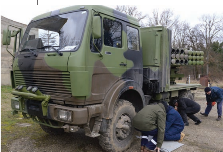
Посиљављање вага које мере силу ослањања
