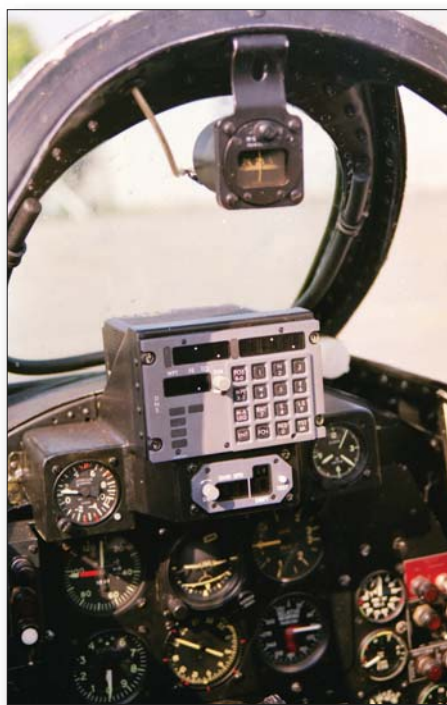
Показивачи навигационог система у првој кабини „јастреба“ – горе је рачунар, а доле показивач брзине (ВОЦ)
