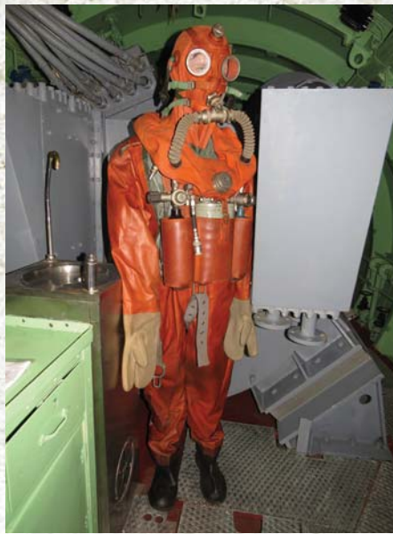
Подморница „херој“ сада има само једног „члана посаде“ – пластичну лутку са сјасилачком опремом ИСП-60, која је омогућавала да подморничар изрони са дубине од 100 м, изузетно од 120 метара
