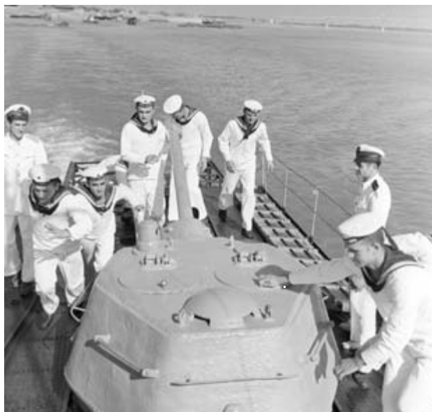
Прамчана тенковска купола на РОЧ-200 била је са Т-34 касније производње
