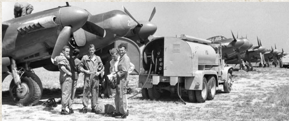
Аутомобил цистерна за гориво CSCW 353 од 4.000 l за појуну горивом авиона „москиџо Mk38“ из 103. извиђачког пука, 1955. године на аеродрому Бајшајнци
