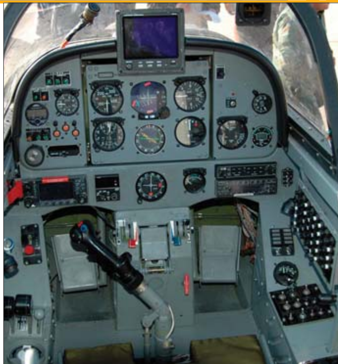
Инструментална табла предње кабине (горе) и детонационо сечиво система за катапултирање (доле)
