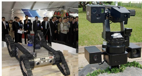
Korejski robot graničar sa nezgrapnom nadgradnjom robotizovanog mitraljeza i senzora
