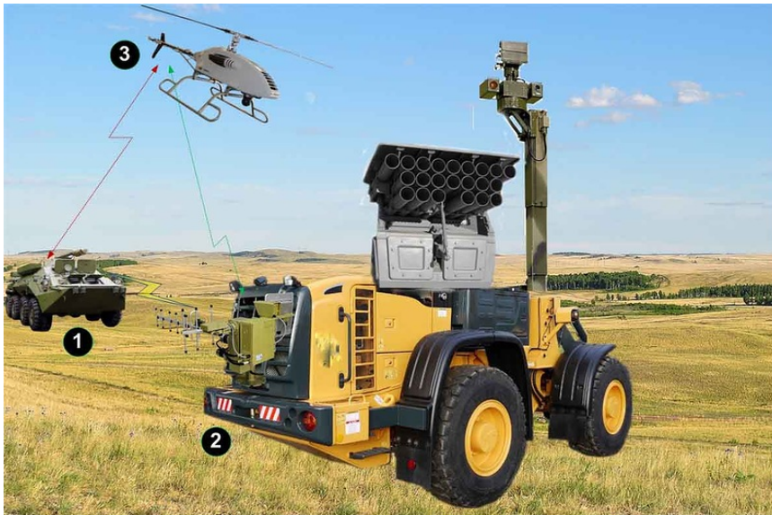
Pretpostavljene konfiguracije samohodnog borbenog vozila sa 22 cevi bacača granata, pri čemu se upravljačka stanica nalazi u oklopnom transporteru (1), lansirni sistem na MRK platformi (2), a osmatranje i navođenje obavlja se bespilotnom letelicom (3)
