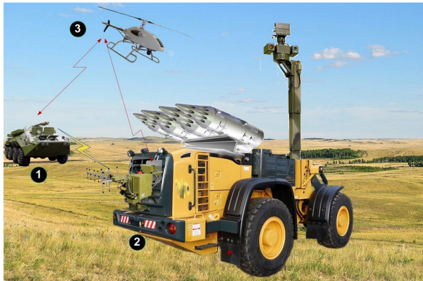
Ilustracija prototipa konfiguracije mobilnog sistema robotskih višelansirnih raketnih kompleta sa četiri lansera B8M-1.
