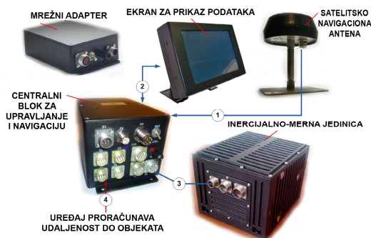
Žiroskopski uređaj u kompleksu za orijentaciju i navigaciju „GKU-500”
