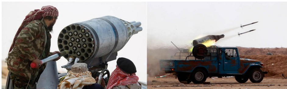
Improvizovana upotreba raketnog lansera B8M-1 sa pikap vozila tokom rata u Libiji 2011. g.
