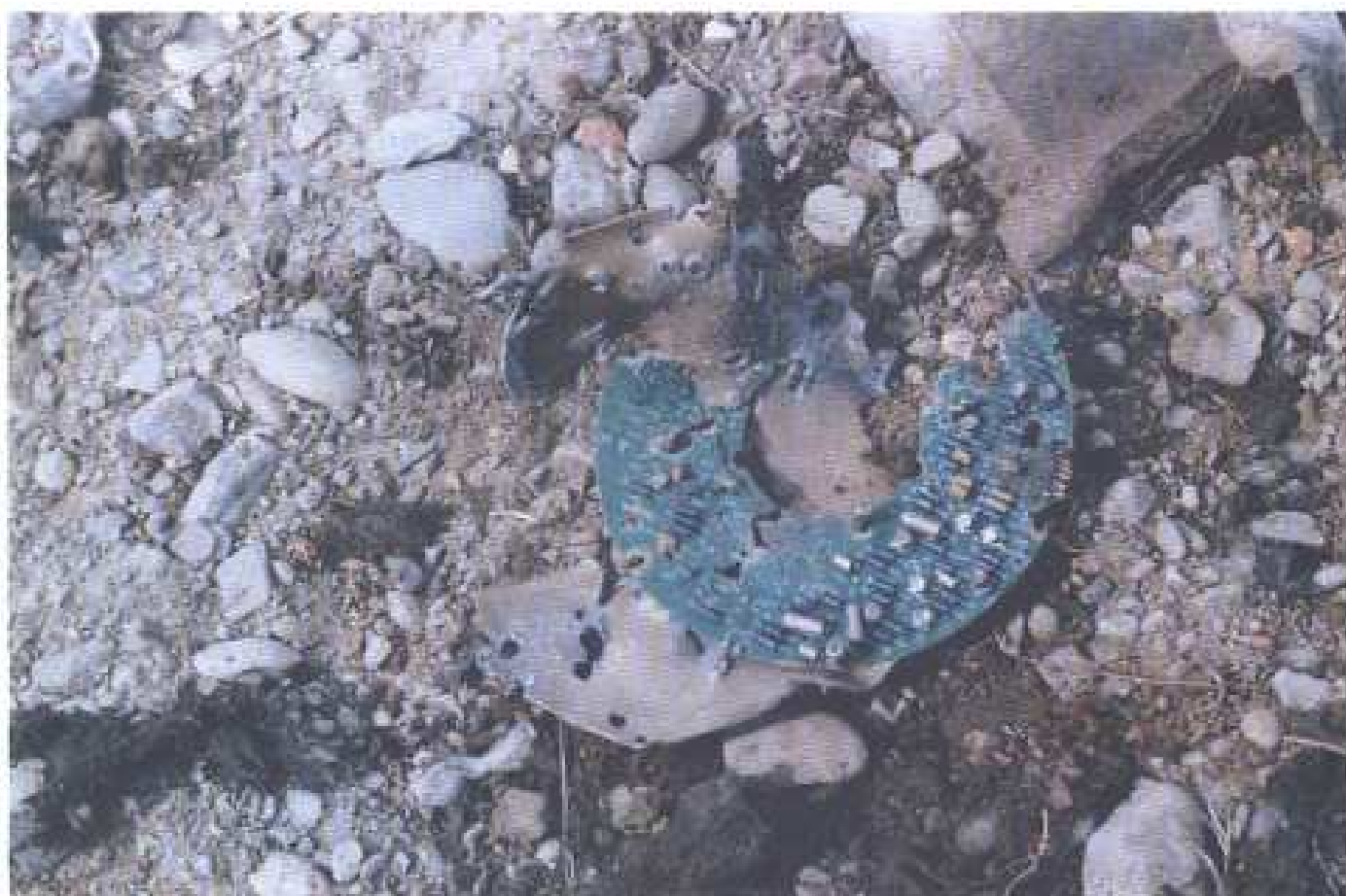
Слика 32 Делови главе за навођење пројектила којима је бомбардована колона
